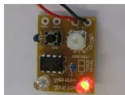
⑥電気機器組立て （LED表示タイマー）
