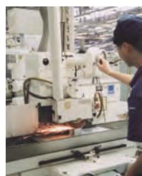
平面研削盤作業の実施風景
