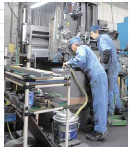
先輩技能者が立型旋盤の段取り作業（芯出し作業）を熱心に後輩に指導し、技能を継承する
