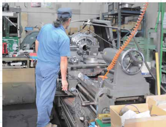
普通旋盤で航空機部品の旋削加工を行う
