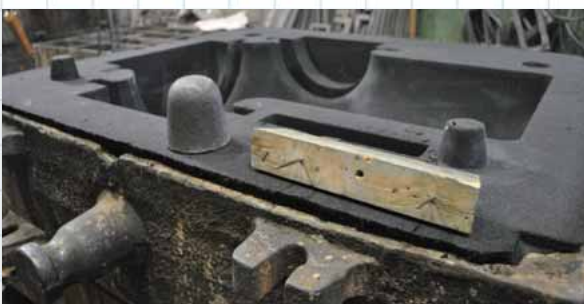
工場内の様子：砂で製作した鋳型
