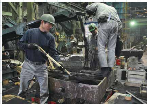
工場内の様子：鋳型へ砂を流し込む技能士
