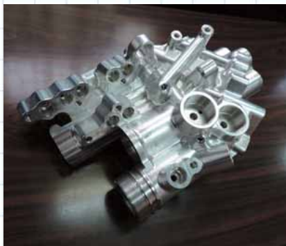
F1エンジンの心臓、シリンダーヘッド。マシニングセンタ技能の高さが精密な加工を実現する。
