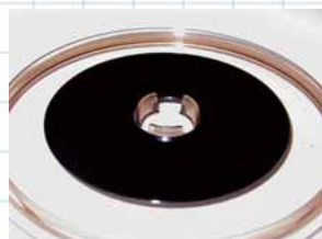
二次電解によるアルミ材への 直接めっき（特許）
