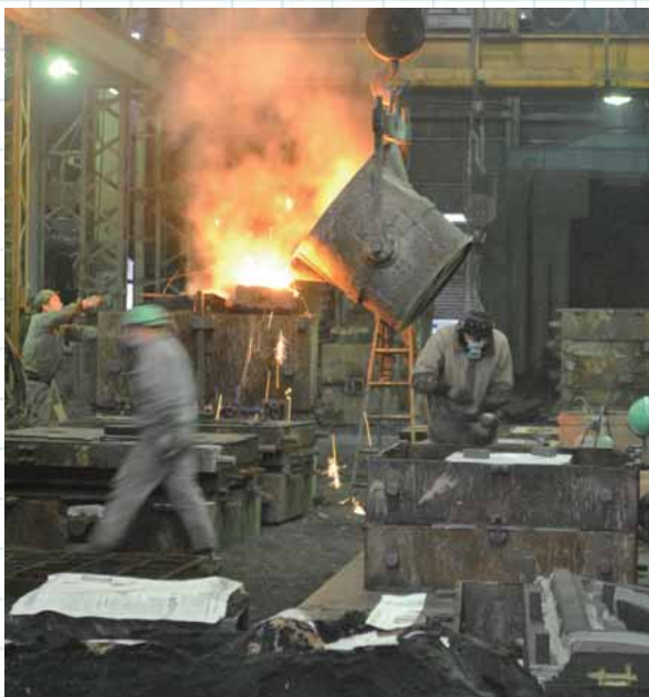
工場内の様子：鋳型へ注ぎ込まれる鉄の湯
