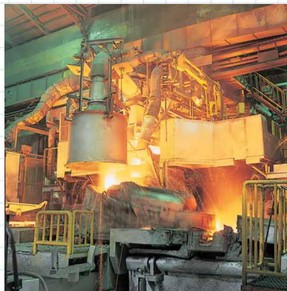
長時間連続操業を可能にした自社開発溶解設備
