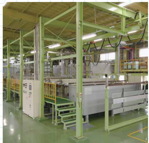
アルミニウムへのめっき、陽極酸化処理を行う東工場
