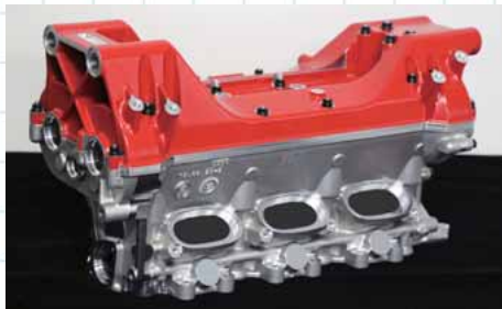
F1エンジンの心臓、シリンダーヘッド。マシニングセンタ技能の高さが精密な加工を実現する。
