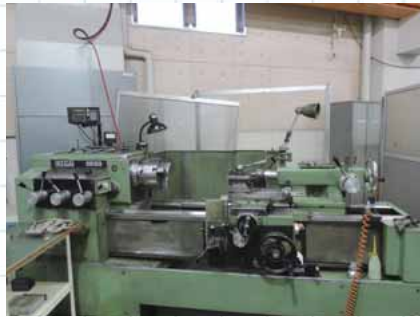
汎用のフライス盤（左）と旋盤（右）。出番は少なくなったが、今でもきちんと稼働する。
