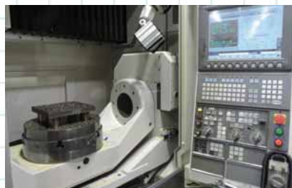
右のプログラミング板で、ち密な切削加工を制御する
