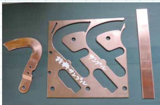
従来は型を抜いていたが、現在は一本の板(右)から型を作る
