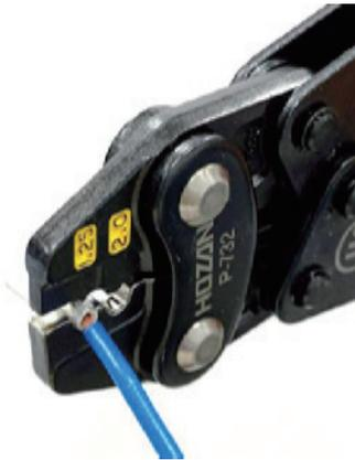
圧着作業は圧着端子のスリーブ部分に被覆を剥いた芯線を差し込み、圧着工具でスリーブ部分を押し込んで接続します。圧着端子または圧着工具のサイズが電線に合っていないと接触不良や断線の原因になるので作業時は注意しましょう。
