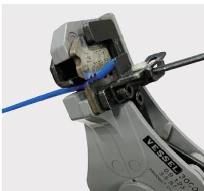
電線サイズ(径)に合ったワイヤストリッパの被覆剥き位置(穴)に電線をセットして端子に合わせた適正な長さに被覆を剥く。
