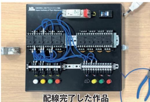
写真は①～⑤の N ラインを配線・接続している場面です。端子接続部分では 2 個の圧着端子を接続する部分があります。端子の背面同士を重ね、端子台の奥まで差し込み、上下 2 つの端子を揃えて端子ねじを締めます。
