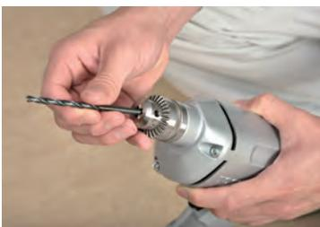
④ 電動ドリルに端子台及びアース端子の穴径に適したドリル刃を取付け、チャックキー（専用工具）でしっかりと固定する。
