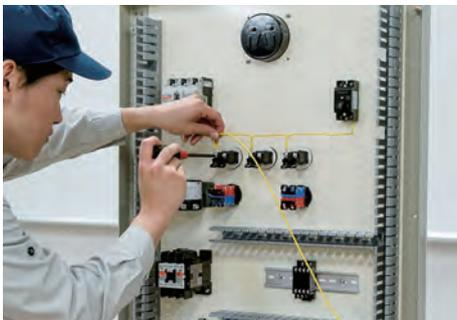
配線経路を記入した接続図を見ながら、器具の端子間に電線を現物合わせして測長し、適切な長さに切断する。
