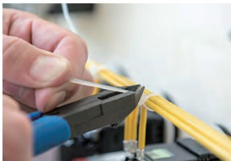
配線が終わったら束線材を使用して、写真のように結束する。結束によって、電線の束が占める空間を小さくしたり、振動による電線同士の擦れ合いを防止できる。
