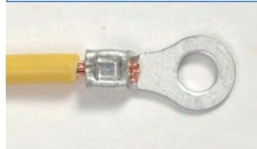
圧着端子の圧着不良例
