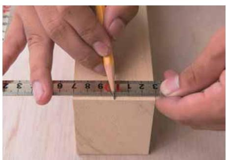
・各部材の両端に、幅方向の中心をさしがねを使って鉛筆で印す。
