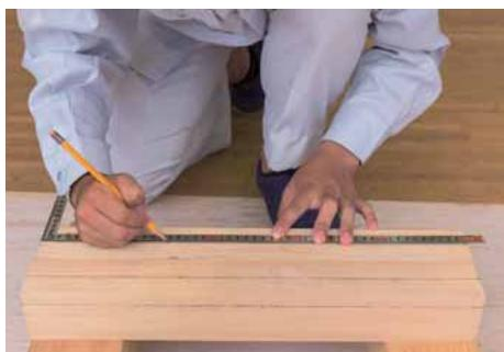
妻手を材料の端に合わせ、長手の真ん中あたりを持ち、長手の外側で線を引く。直角に引くためには、長手を材料にきちんと密着させる。
