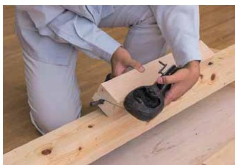
・つぼ糸を材料から離し、材料を回転させる。
