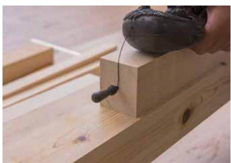
・墨つぼから軽子を引き出し、材料の端の中心に刺す。
