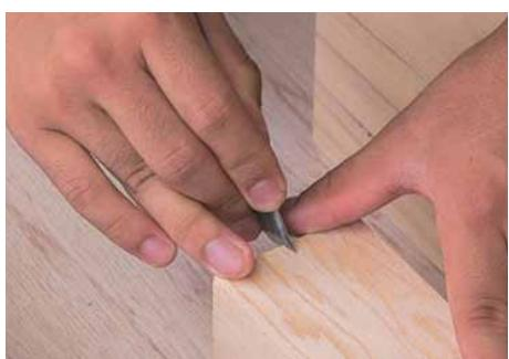
・しらがき、カッターナイフ、けびき等で、材料の両端に切り欠き溝を付ける。
