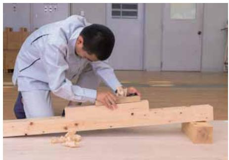
⑦ 実際に削ってみて、材料の幅一杯の削り屑が出ているか確認する。
