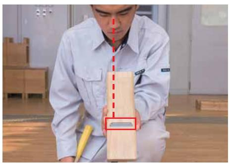
② 本刃の出具合を、台尻のほうから台を傾けて刃先だけが見えるようにする。(0.05～0.2mm出ている状態)
