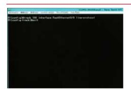
2台以上のルータをVRRPグループに追加する。VRRPグループに、共有して使用するIPアドレスを一つ持たせる。これにより、共有しているIPアドレスをデフォルトゲートウェイにすることで、ルータに障害が発生した場合でも、クライアントは設定を変更することなく、通信できる状態を保つことができる。
