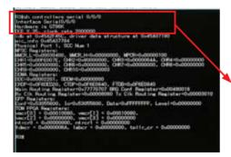
左図は、ルータ3に接続されたシリアルケーブルの状態を確認した結果リスト。DCEかDTEのどちら側が接続されたか確認できる。同様にルータ2の接続も確認する。
