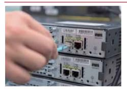
LANケーブルを接続し、通信できるようにする。 接続表を確認しながら、1本ずつケーブリングを行う。
