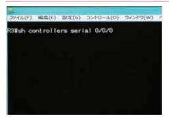
R3にDCE、R2にDTEとして、シリアル接続されているか確認する。
