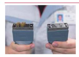
DCEとDTEは接続部を見て判断する。DCEは穴が開いており、DTEは端子が出ている。
