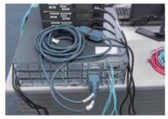
シリアルケーブルは、 DCEとDTEを組み合 わせて使用する。
