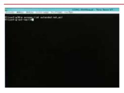
設定方法は、アクセスリストを作成し、変換対象となるネットワークを指定する。その後、作成したアクセスリストと変換後のIPアドレス(今回はインターネット側のインターフェースのIPアドレスとした)を指定する。
