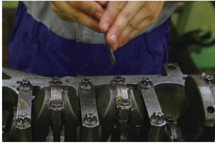
コンロッドキャップを取り外す。マニュアルに従い、分解する前に上限値と下限値の隙間ゲージを使って隙間が基準値範囲にあることを確認する。
