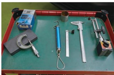
各測定機器（ダイヤルゲージ、マイクロメータ、ノギス、バネばかりなど）は事前に校正しておく。
