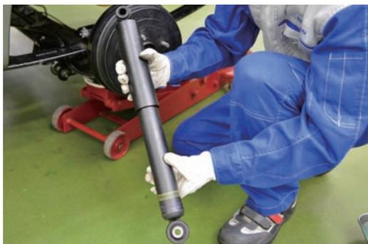
ショック・アブソーバの取付け、ボルトの取外し方と取付方法に注意して交換する。
