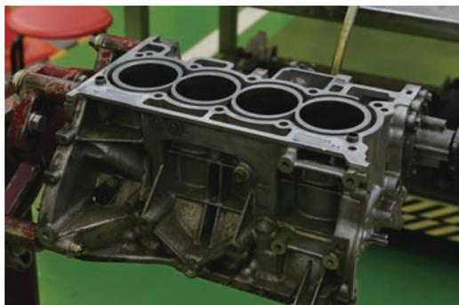
シリンダ・ボア径（円筒内径）を測定する。
