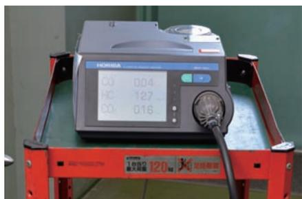
COHC アナライザ（4 ガスアナライザ）の校正（ゼロ確認）をするため、しばらく暖機しておく。
