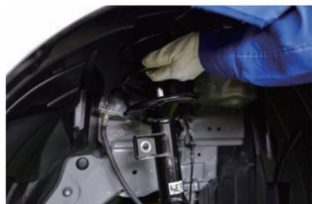
3つのボルトのうち、一番奥のボルトは見えづらいところにあつて外しにくいので、手前の2つを緩める前に奥を先に外す。手前の2つを外す際はストラットの重量がボルトにかかってくるので、手と足を使いながらストラットの位置を調整して、ボルトを外す。
