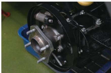
ホイールシリンダを取り付け、他の部品も元のように組み付ける。部品の向きを間違えないようにし、スプリングを伸ばしながら引っかけるなどして組み付けていく。組付け時、マニュアル指定箇所にグリスを塗る。
