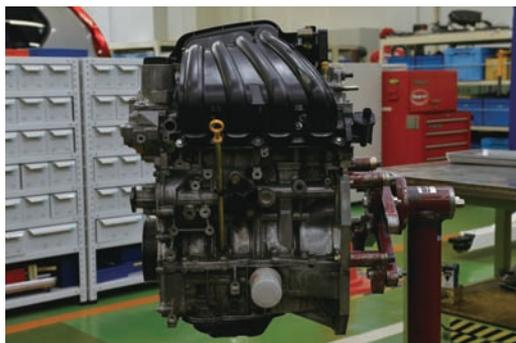
汚れを拭き取りながら潤滑油をさし、組み立てる順序、順番に留意しつつねじを締め付けていく。タイミングチェーンの取付方法に注意しながら作業を行う。
