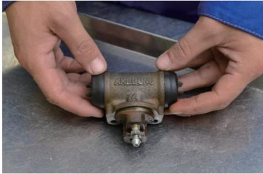
分解する時のフルードの抜き取り作業とピストンカップの交換作業、金属接触を避ける為のグリスを塗る作業を順序良く行う。
