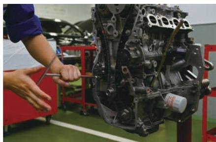
ロッカーカバーを外したら、エンジンを手で回転させ、クランクシャフトとカムシャフトの位置（1番圧縮上死点）を確認しておく。
