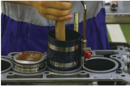
エンジンスタードをターンさせ、潤滑油をさして、ピストンリングコンプレッサを用いてピストンを挿入する。最初に中央の2つをセットし、両端2つを後から取り付ける。ピストンの位置と向き、及びピストンの合口を確認しながら取り付ける。
