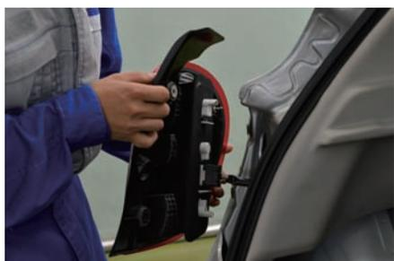
テールランプユニットを切り離しテストで導通点検をする。
