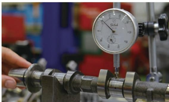
カムシャフトの曲がり測定するには、棒の両端を支点にして回転させ、最も振れ幅が大きくなる中心部の振れ量を測定する。
