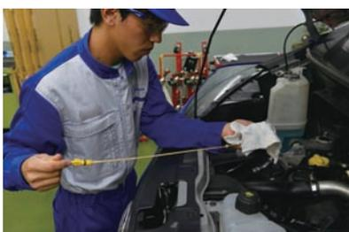
エンジンをかける必要があるので、エンジン始動前に点検を行う。ベルトの張り、エンジンオイルの点検、冷却水のタンクレベル点検をしておく。
