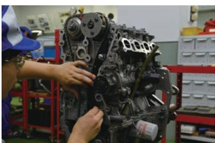
潤滑油をさしたタイミングチェーン、チェーンテンショナの順に取り付けていく。ピストンの1番を圧縮上死点の位置に置き、チェーンの黄色のマーク（2箇所）が上の溝の位置に来るようにセットする。タイミングチェーンをつける場合、黄色とオレンジマークを合わせる。
