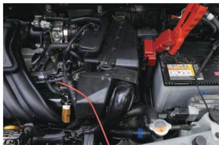
オシロスコープを接続して、インジェクタ噴射波形を確認する。
