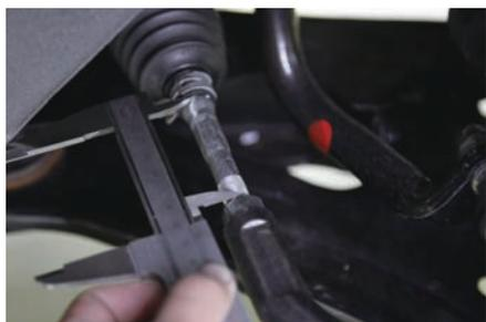
アウトソケットを外す前に、ホイールアライメントが変わってしまう（ステアリングの位置、車の直進状態が変わってしまう）のを防ぐため、取付けの長さをあらかじめノギスで測定しておく。ソケットを緩めるときは、ダブルスパナで行う。（右写真）
