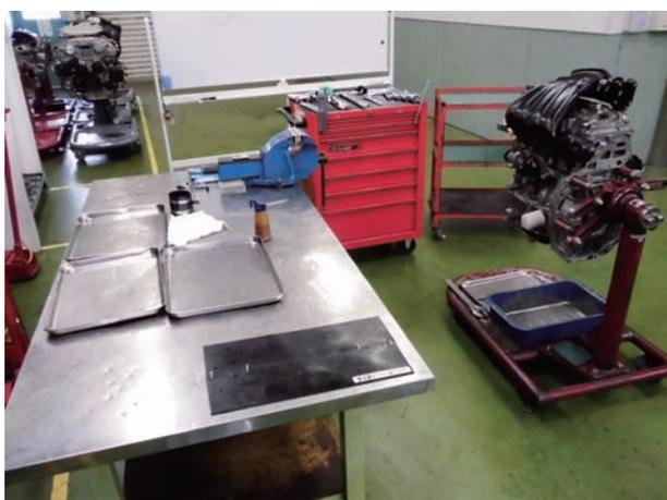
作業に必要な手工具類を工具箱に収め、作業台、工具箱、部品台、エンジンスタンドの位置を作業しやすい配置で整える。トレーや定盤等も作業台に配置する。
