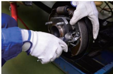
ブレーキを分解してホイールシリンダを取り出す。ブレーキシューにはスプリングが多く利用されているため、組付けが固いことが多く、スプリングを押さえつけて縮めながら分解するなど工夫する。機構が複雑なのでスプリングの取付き方やアジャスタの向きに注意する。
