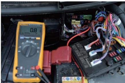
ショート点検を行う。回路図を見てテスタで電気の流れを数値で確認する。
