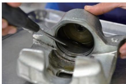
ピストン・シールを交換してシリンダボディに取り付ける。併せて、ピストンブーツも交換する。指定箇所にはグリスを塗る。
