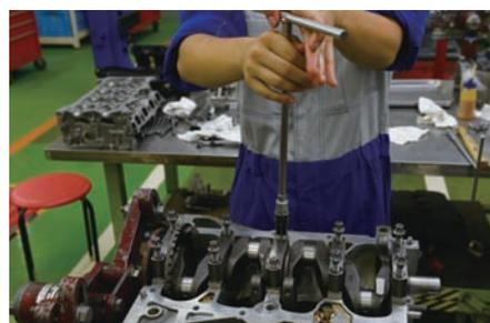
新品のクランクリヤオイルシールを付け、ボルトを締める。回転部分になるので、数回に分けて徐々に締めこんでいく。ボルトは中央、外の順に締める。最初にTレンチで締め、トルクレンチで角度を決めて締める。ここでは正規のトルク値よりトルクを落としてあり、1回目30N・m、2回目が30度の角度締めとなる。回転部分等の重要な箇所は同じように複数回に分けてボルトを締める。
