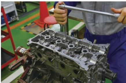
エンジンスタードをターンさせ、新品のヘッドガスケット、シリンダヘッドの順に取り付け、ボルトは中央→外側の順で、指定されたトルクで締める。
