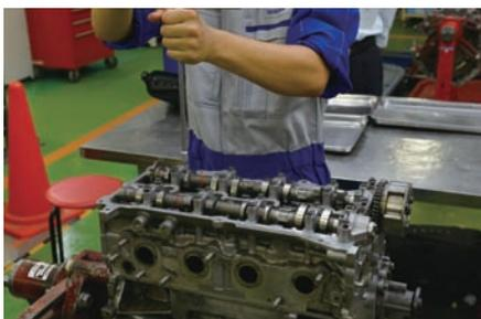
カムシャフトをNo. 1圧縮上死点の位置に置き、カムブラケットの向きと位置に注意して、ボルトを締めて取り付ける。カムシャフトのボルトは3回に分けて締め付ける。カムシャフトはウエスでよく拭き、潤滑油を手でなじませてから取り付ける。
