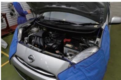
車両を傷つけたり、汚したりしないように、フェンダーカバー、シートカバー、ハンドルカバー、フロア・マットを取り付ける。
