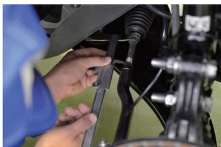
アウトソケットを取り付ける。取付け後、再度ソケット位置をノギスで計り、外す前と同じ位置になっているかを確認する。
