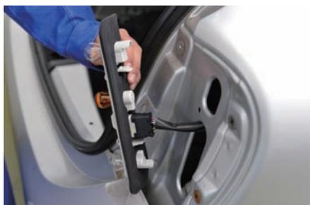
リヤコンビネーションランプユニットが正常に作動するか再度点検する。
