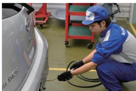
サンプリングプローブをマフラーに差し込み、排気ガスの点検を行う。
