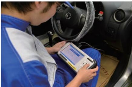
故障診断装置（HDM3000）を使用。故障診断装置をつないで、アクティブテストを行う。
