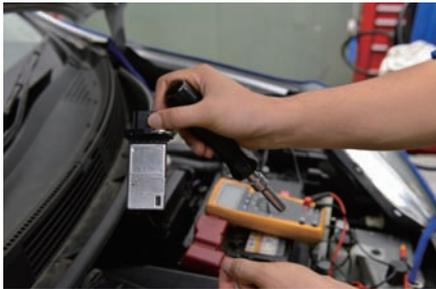
テストでエアフロの電源電圧、アースチェックをする。
