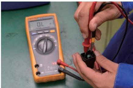
テストでリレー接点の点検をする。
