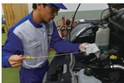
今回はブレーキ・ブースターの点検でエンジンを始動予定のため、エンジン始動前の点検を最初に行う。ベルトの張り、エンジンオイルの点検、冷却水のタンクレベル点検をしておく。
