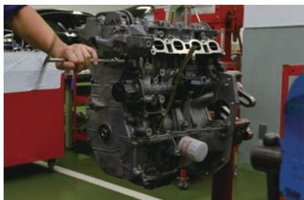
フロントカバー、クランクプーリを取り付ける。締付けはマニュアルの順番どおり行う。ボルトは、原則として、細いボルトから緩め、太いボルトから締める。
