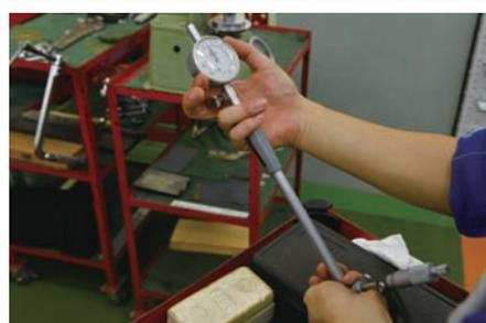
内径の汚れをウエスで拭き取る。内径に傷がないか合わせて確認する。
