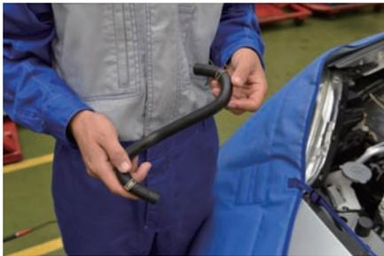
外観チェックやエンジン始動時の負圧漏れの音の有無で確認して、バキュームホースに穴があいていないかを判断する。
