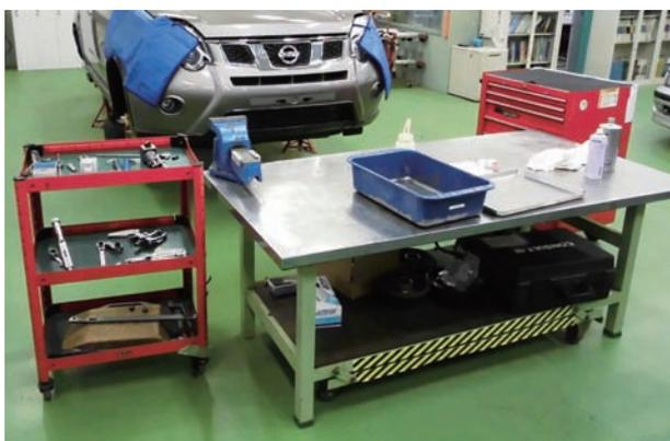
作業に必要な工具類を工具箱に収め、作業台、工具箱、部品台、車両の位置を作業しやすい配置に整える。エア設備が必要になるので、その配置も忘れない。油圧ジャッキも手近な場所に配置しておく。フェンダーカバー、シートカバー等は競技開始後に選手が取り付けるのでその場に用意するにとどめる。
