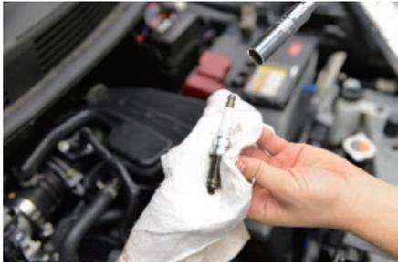
No. 3に不良があると判断できたので、No. 3の火飛びの確認をする。プラグを点検する。
