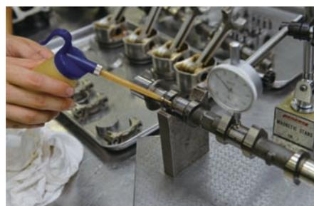
測定具を部品上で滑らせる場合は、傷がつかないように潤滑油（エンジンオイル）を塗布する。
