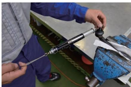
ボールジョイントを4方向で測定する。万力で固定して、ばねばかりのゼロ確認をしてから測定する。前後左右になじませてばねばかりで動き始めを測定する。最大の数値を測定値にする。測定値の記入時は単位に注意する（ニュートン（SI単位）で記入する）。
