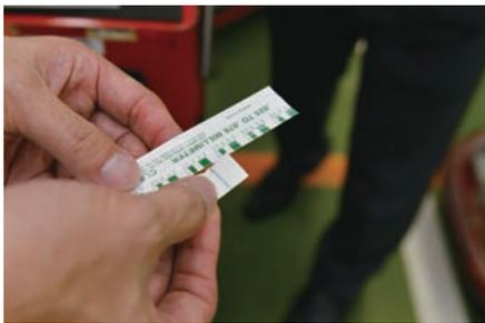
組付け作業の無駄を省くため、ピストン等は通常どおり組付けを進めていき（次頁⑦エンジン組立て参照）、その組付け過程の中で測定箇所のクリアランスを測定する。測定にはプラスチックゲージを用いる。測定するNo.2コンロッド・ベアリングだけは潤滑油を塗布せず、該当箇所を組み付ける前に拭き取り清掃をしてからプラスチックゲージをセットして測定する。
