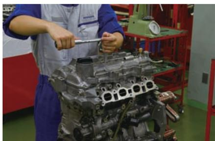
ロッカーカバーガasketを新品に交換し、ロッカーカバーを取り付ける。
