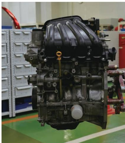
ガソリン・エンジンを整備のため分解し、エキゾースト・カムシャフト、クランクシャフト、シリンダ・ボア径、オイル・クリアランスを測定した後、組み立てる。正しい手順で分解して、必要な検査を行い、逆の手順で正しく組み立てられるかを見る。
