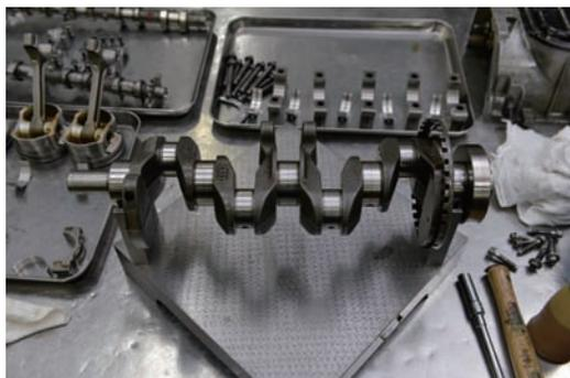
測定した時の外径寸法が基準値（マニュアルに表示）の範囲内から逸脱していないか確認することで、正確な測定結果か、ある程度判断できる。
