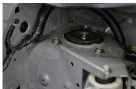
ストラットがついている上部の取り付け部の3箇所のボルトのトルクを緩める。
