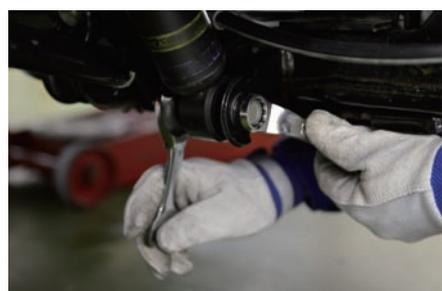
ねじ山が壊れることがあるので、ボルトは決して回さず固定したまま、ナットを回して緩めていく。ナットが硬く緩まない場合はスパナをたたく等工夫する。外すときの順番を下→上、締め付けるときの順番を上→下とすると、ボルトを抜き差ししやすい。
