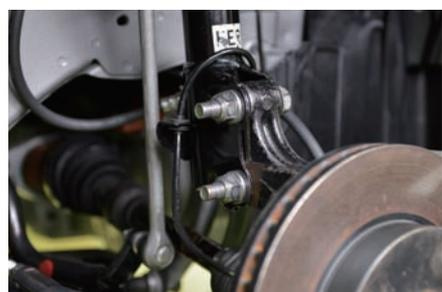
フロント右側のロックプレートと車輪回転センサをステアリングナックルから取り外す。
