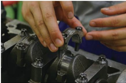
エンジンスタードをターンさせ、ピストンにコンロッドキャップを付けボルトを締める。コンロッドキャップの位置と向きに注意する。
