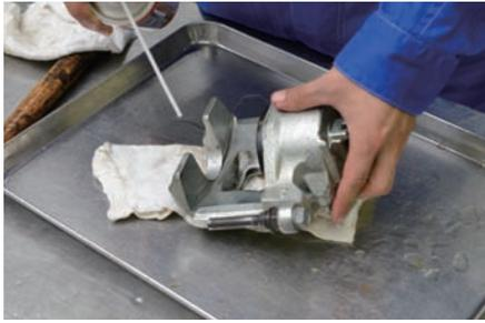
ブレーキ・キャリパの組立て後、表面に残っているフルードをクリーナーで洗浄する。
