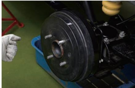
ドラムを元に戻す時にハブボルトとドラムの位置がずれないように、チョークでマークを付けておく（位置がずれると回転時の重量バランスがくずれ、振動につながる可能性がある）。
