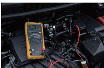
テストでカムポジの電源電圧、アースチェックをする。
