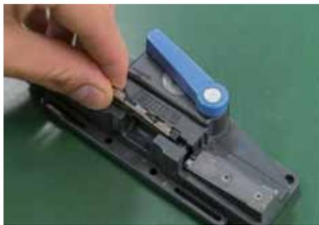
メカニカルプライスをセットした後、ホルダーをメカニカルプライス接続治具にのせる。
