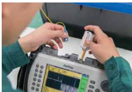
OTDR のレセクタブル部及び光コードの光コネクタ端面をクリーニングし、OTDR に接続する。
