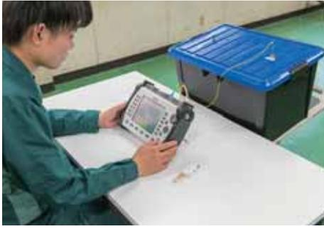
伝送損失や距離測定、断線箇所の検出、融着／メカニカルスプライス／コネクタ接続などの接続損失や反射量(反射減衰量、リターンロス)などを OTDR で測定する。
