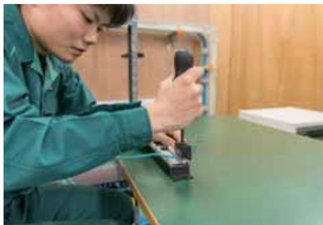
結線後、インパクトツールで線を押し込むとともに、不要な線を切断する。
