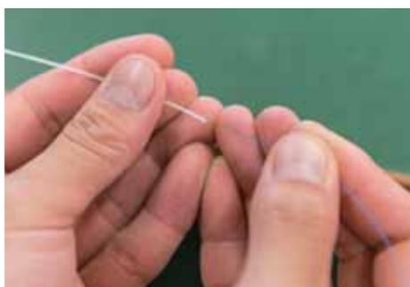
光ファイバの反対側から保護チューブとブーツを差し込む。
