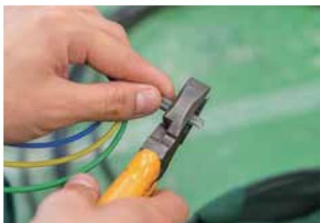
ペンチでスロットロッドのプラスチック部を除去し、銅線を露出させる。
