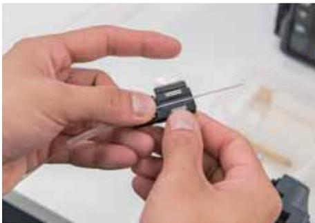
同様に光ファイバをホルダに取り付け、被覆を剥ぎ切断する。
