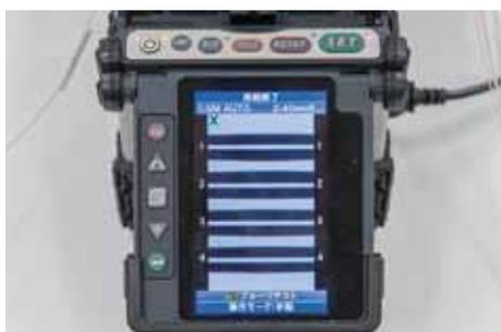
引っ張り試験で接続強度を確認し完了する。
