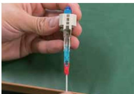
ソケットを上げ、ソケット内面に沿って光ファイバを挿入する。
