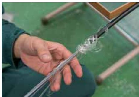
光ファイバを保護している押え巻き糸を外すと光ファイバが現れる。
