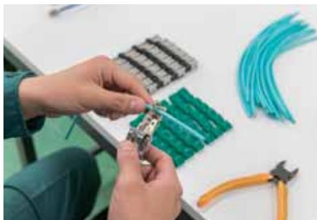
外被むき工具を一回転させて U/UTP ケーブルの外被に切込みを入れる。
