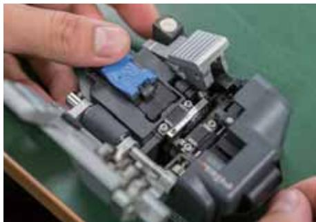
光ファイバをカッタで所定の長さに切断する。
