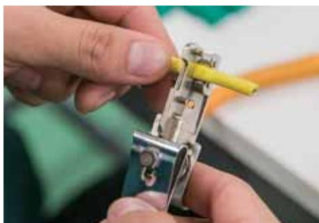
ケーブル外被の先端から約50mmの位置に切込みを入れ、外被を除去する。
