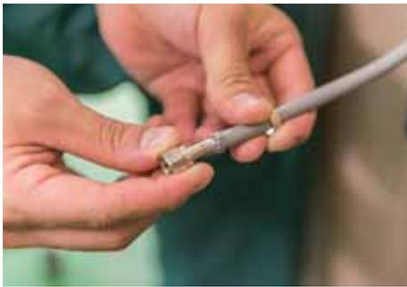
同軸コネクタ(F型コネクタ)を同軸ケーブルに成端する。
