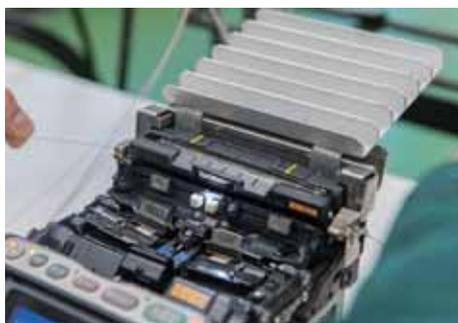
加熱して光ファイバ補強スリーブを固め、融着機の外で1分程度冷却する。
