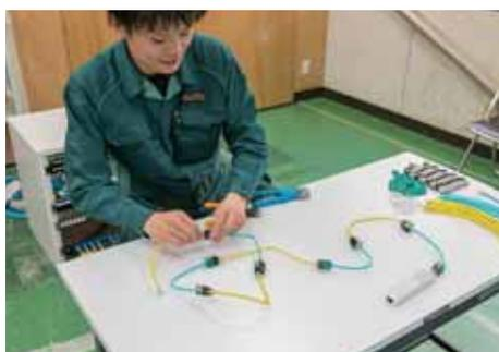
モジュラジャックとモジュラプラグを交互に製作し、1本ずつケーブルをつなぎ、導通確認する。
