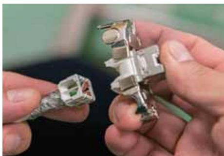
モジュラジャック金具を取り付け、シールド網を結束バンドで固定する。
