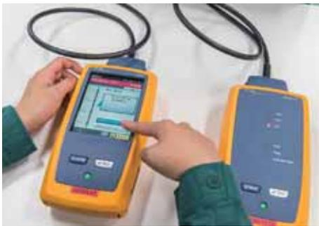
測定前に、「ケーブルの種類」、「ケーブル規格」、「アウトレットの種類」の3項目を設定する。
