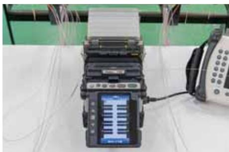
開始ボタンを押すと画面に端子位置、軸ずれや端面間の距離が表示される。
