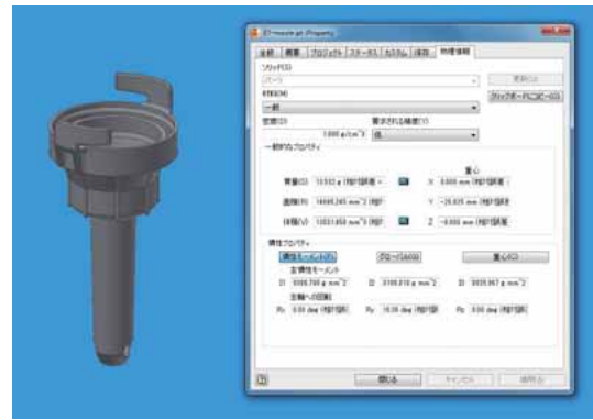
(b) ノズルのマスプロパティ画像
