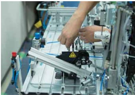
拡散反射センサ(196959)をI/O端子台に接続する。
