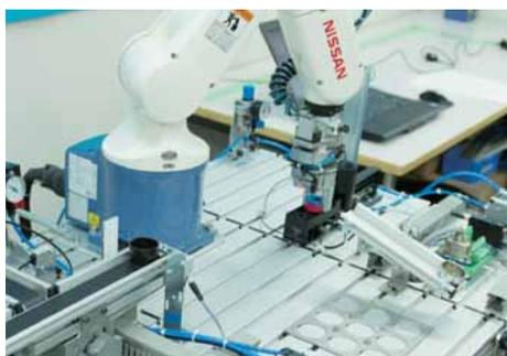
ロボットはディストリビューションsta.からキャップ付ワークを第4スライドに運搬する。
