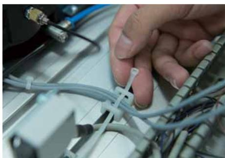
マガジンモジュールとロボットの動作によって光ファイバが干渉しないようにケーブルホルダに束線する。
