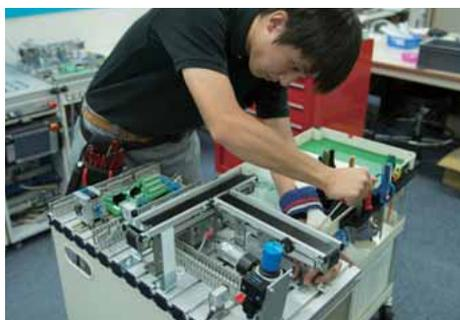
ソーティングsta.(DA-SA1)のP&Pモジュールが、第3スライド位置から90度左回転して第1昇降シリンダを下降させた時にワークを供給できる位置にコンベア1を取り付ける。
