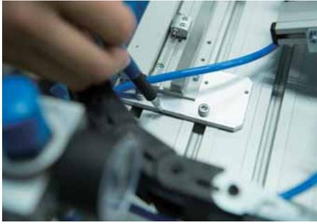
ベースプレートの取付位置をプロファイルパネルに印をつけ、リニアシリンダをベースプレートと一緒に取り外す。
