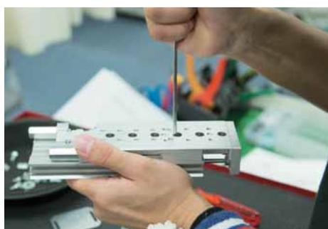
第1昇降シリンダ(197894)の位置調整後、第2昇降シリンダブラケット(DD-S05)を取り付ける。
