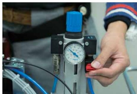
エアバルブを閉じ、エアを止める。リニアシリンダのエルボからチューブを外す。
