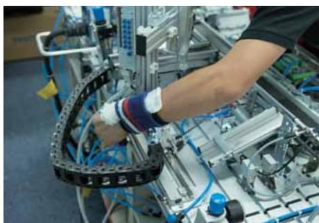
近接スイッチケーブルをケーブルキャリアを経由してコンベヤsta.のI/O端子台まで配線する。
