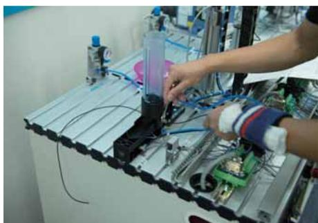
マガジンモジュールからセンサーケーブルの配線、エア配管をする。
