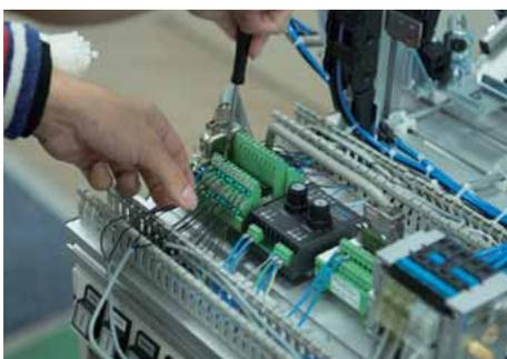
ケーブルをダクトを通してI/O端子台に接続する。
