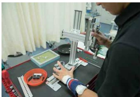
サポート350をロータリーアクチュエータの上に取り付け、手で滑らかに回ることを確認する。
