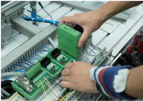
モータードライバー(967245)を取り付け、配線する。モータが正転、逆転することを確認する。
