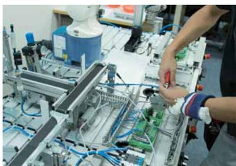
リニアシリンダからバルブターミナルまでエア配管し、ケーブルホルダにチューブを固定する。
