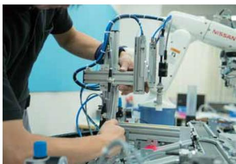
スライド上のワークをピックアップするため、サポート150の高さを調整する。シリンダを下げてワークを吸着できるようにする。
