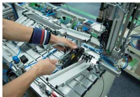
テストステーションのエスケープユニットにあるテンション調整用ねじを緩め、タイミングベルトを取り外す。
