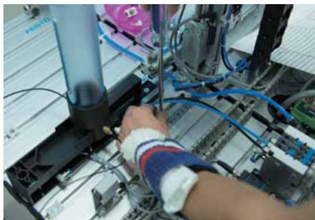
ケーブルホルダをプロファイルパネルに取り付ける。
