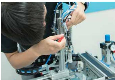
第1昇降シリンダに近接スイッチを取り付け、作動を確認する。
