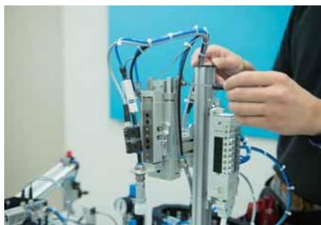
第1と第2昇降シリンダの流量調整をスピードコントローラで行う。
