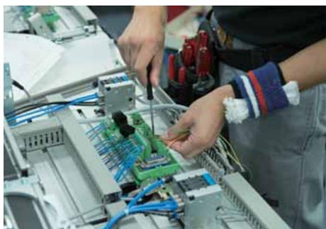
I/O端子台からダクトを経由してトロリ内の配電盤に配線する。
