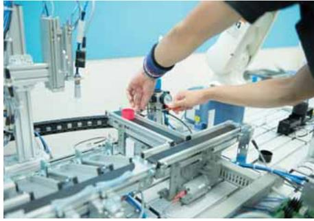
コンベア1のワーク有無センサとコンベア2 終端の近接スイッチを配電盤に接続する。コンベア1のワーク有無センサの感度調整をする。
