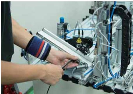
ロータリーアクチュエータを回転させ、エスケープユニットのストップ位置を確認する。
