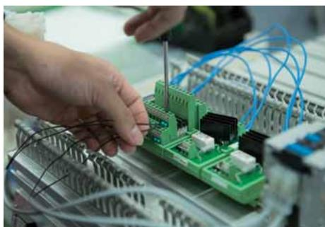
センサセット及びI/O端子からPLCの入出力ユニットに接続する。
