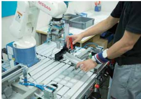
ロボットステーションのプロファイルパネル上に第4スライドを取り付け、ワークが滑らかにすべることを確認する。
