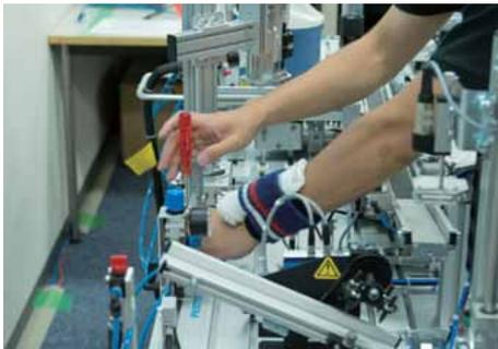
リニアシリンダ(187855A)の付属ストッパを図の寸法位置に取り付ける。
