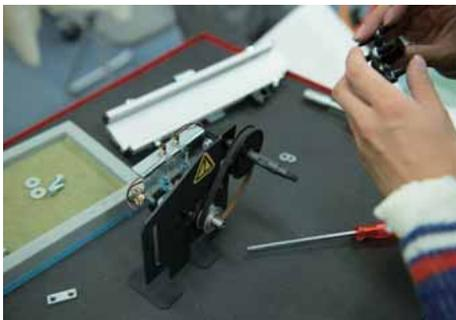
シャフトASSY(DA-T03)、タイミングプーリ(大)(HTPB-50S3M060-A-N10)、タイミングプーリ(小)(HTPA-25S3M060-A-N10)及びタイミングベルト(HTBN273S3M-60)、ピボットASSY(DA-T05)を取り付ける。
