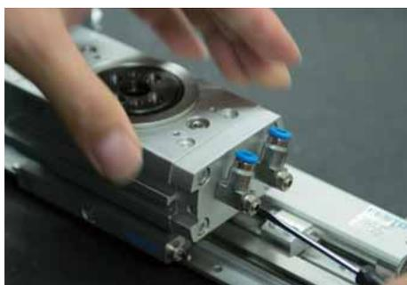
スピードコントローラを取り付け、併せて回転角度範囲の仮調整をショックアブソーバで行う。
