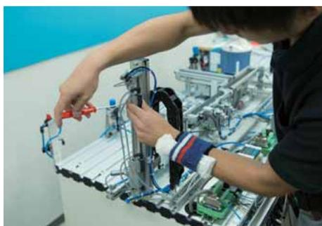
リフトモジュールに近接スイッチを取り付け、ケーブル付ソケットに接続し、エアチューブや配線を束ねる。
