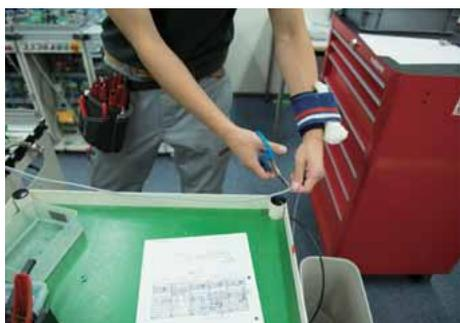
長さを合わせてケーブルを切断し、外装を剥ぐ。
