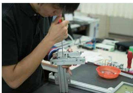
第2昇降シリンダを第1昇降シリンダに取り付ける。ブラケット(DD-S07)を第2昇降シリンダに取り付ける。
