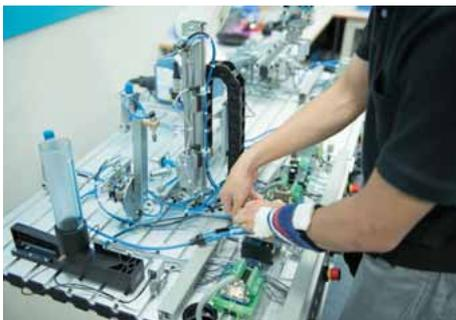
変更されるエアチューブを取り外し、使用しない部品を取り外す。再利用する部材と使用しないものを分けて保管する。
