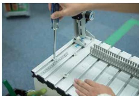
ケーブルホルダ配置図(DL-GA2)に基づきケーブルホルダを取り付ける。
