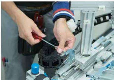
P&Pモジュールの取付金具にケーブルキャリアを取り付ける。ボルトの締め付けはP&Pモジュールのロータリーアクチュエータの回転調整後に行う。
