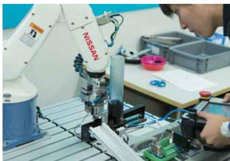
ハンドを移動し、ワークを掴む。搬出位置に移動してワークを置くという作業をワーク毎に行う。
