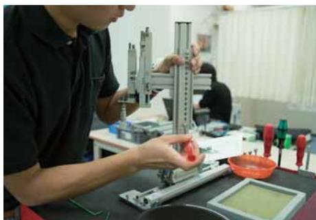
サポート350の背面にDINレール(DNR315-200)を取り付け、ユニットを完成する。
