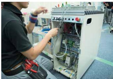
反射形センサのケーブルをPLCの入力ユニットに接続する。
