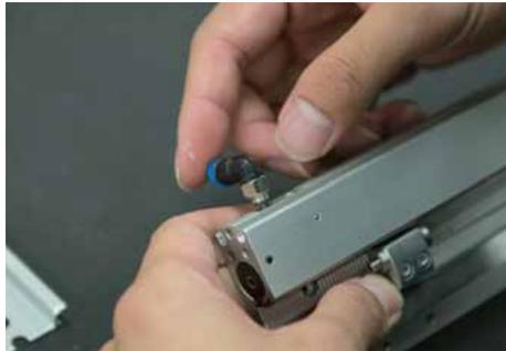
リニアシリンダ(187855A)の両サイドにミニエルボ(153332)を取り付け、リニアシリンダにベースプレート(DD-S02)を取り付ける。
