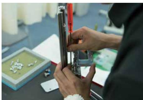
ロータリーアクチュエータにケーブルキャリア取付用のブラケットを取り付けた後、ロータリーアクチュエータをリニアシリンダ(187855A)に取り付ける。
