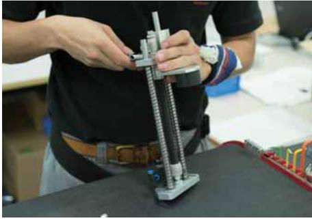
エアシリンダにエルボを取り付け、エアチューブを接続する。
