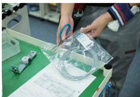
ケーブル付ソケット(159420)を開封し、テストステーションから移設した反射形センサセット(196969)及びケーブル付ソケットを組み立てる。
