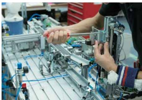
リフトスライドのワーク計測用のブラケットにカバー(DD-T13)、カバー2(DD-T14)を取り付ける。
