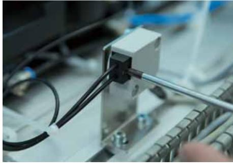
マガジンモジュールの近接スイッチの配線と透過型光電センサの配線をケーブルホルダに束ねる。
