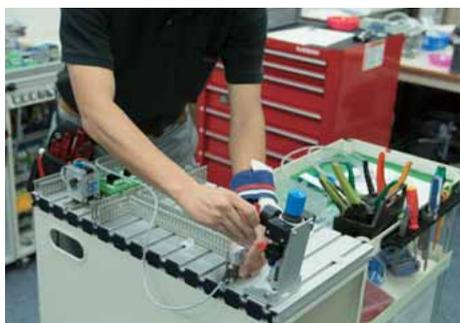
反射形センサセットを取り付ける。
