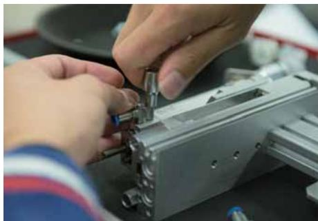
第2昇降シリンダにスピードコントローラ(175038)を取り付ける。
