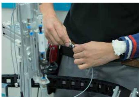
配線ミスを防ぐためケーブルに印をつけてから近接スイッチの端末処理を行う。
