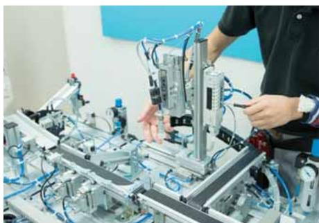
真空圧力センサの動作圧力を設定する。
