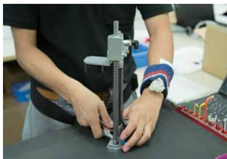
プレスアーム(DD-N03)にパンチ(DM-04)を取り付ける。それをベアリングガイド(DA-N06)に取り付ける。バネを取り付けベアリングガイドに通す。
