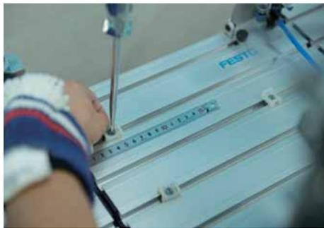
テストing sta.のプロファイルパネルにケーブルホルダを取り付ける。
