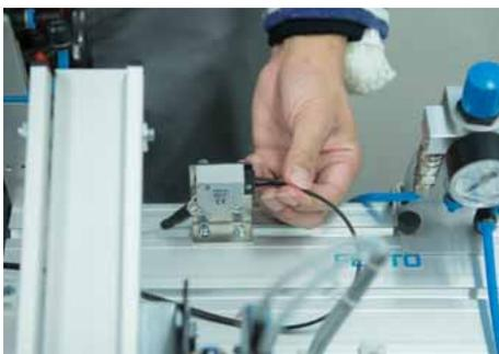
I/O端子台にエスケープユニットで使用されるケーブルを配線する。エア配管をケーブルホルダに固定する。
