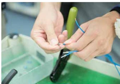
I/O端子台とカレントリミッタを接続するケーブルを作る。
