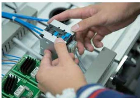
ソレノイドバルブを手動で動作させながらスピードコントローラの流量調整を行う。
