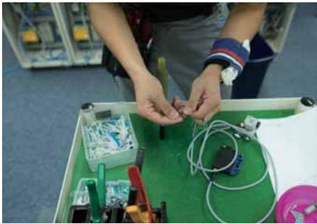
マッスルプレスを作動する圧力をモニターするために圧力センサ(152616)を取り付ける。ケーブル付ソケット(158960)はI/O端子台に接続をする。
