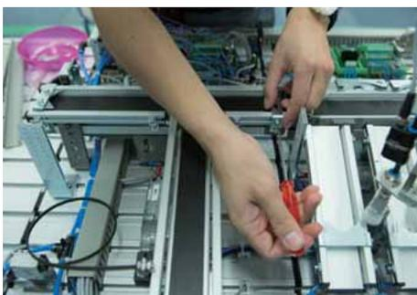
プレスする位置にワークを止めるエンドワークプレート(360166A)と反射センサ(196959)をコンペア2に取り付ける。ワーク検知のセンサの感度調整をする。
