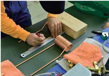
曲げる箇所の銅管外側からの長さを課題図面から読み取る。耐火レンガにスパイラル部分を押しあてて固定し、スケールを当てて曲げる箇所をマーキングする。
