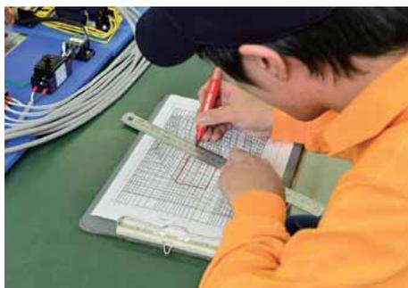
測定値から必要な情報を *p-h* 線図上にプロットし、冷凍サイクルを赤鉛筆で作成する。
