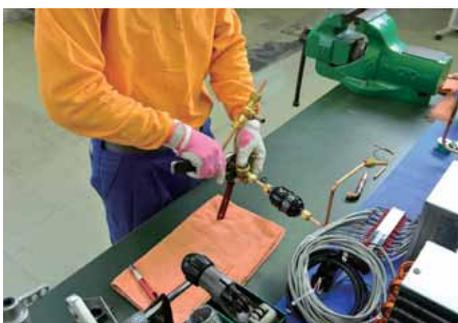
電磁弁をサイトグラス側にフレア接続する。目視により向きや角度を確認し、確実に締め付ける。
