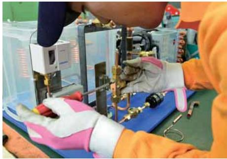
電磁弁を支持金物Bに固定する。
