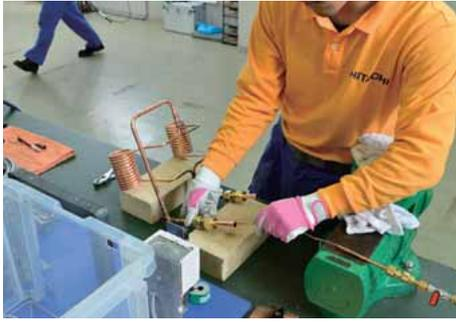
窒素ブロー用の細管を銅管の一端に挿入して、キャップを装着する。
