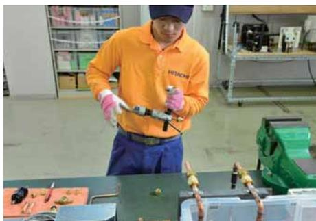
電磁弁に接続する側の管端をフレア加工する。
