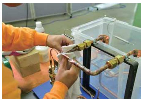
ロウ付け部確認後、濡れたウエスで冷却する。
