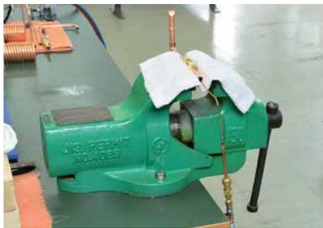
ロウ付けする銅管に窒素ブロー用の細管を挿入して、キャップを装着し、窒素が流れていることを確認する。
