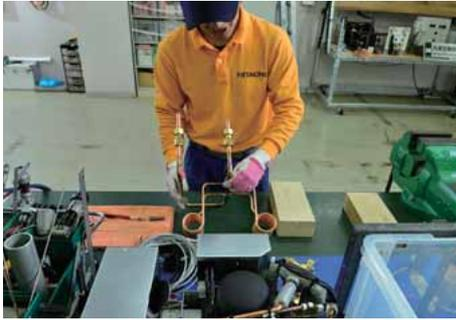
目視によりロウ付け部分の接続状態を確認する。
