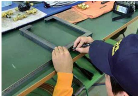
課題寸法に適合するようにスケールを使用して、サドル及び支持金物Eを取り付けるボルト穴の位置を支持金物Aに正確にマーキングする。
