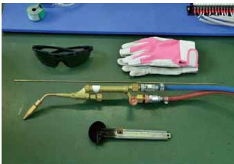
ロウ付けによる接続作業で使用する工具類。
