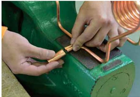
製作加工したパーツの2本の銅管を挿入する。
