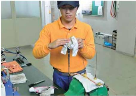
濡れたウエスにより加熱部の冷却を行う。
