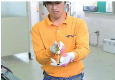
銅管とフレア継手の直線性を、再度確認する。
