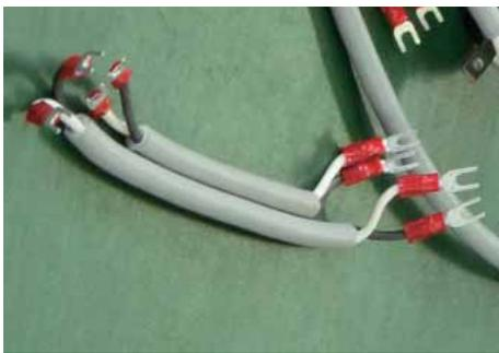
電源端子台の一番上の端子に接続する長さで切断し、端末加工を行う。
