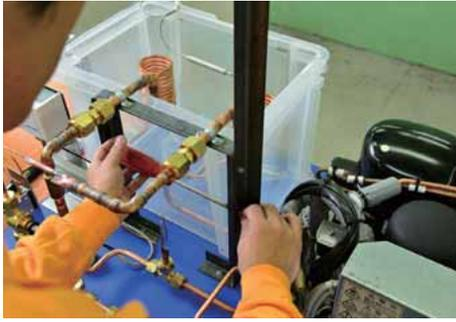
支持金物Aに穴あけ加工した支持金物Eを取り付ける。
