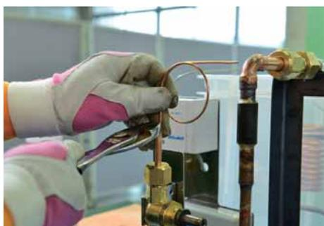
曲げ加工したキャピラリチューブをマーキングした位置まで挿入し、プライヤでかしめる。
