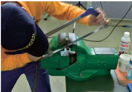
適宜切削油をさし、弓ノコを使用して切断する。
