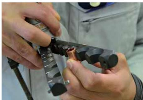
銅管の規定寸法 (0~0.5mm) をフレアダイス面から頭出しする。
