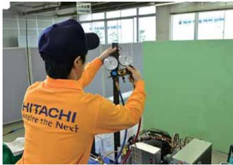
ゲージマニホールドをサービスポートに接続し、支持金物Eに取り付ける。
