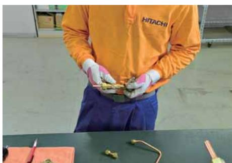
ダブルスパナを使用して、電磁弁と製作したパーツのフレアナットを締め付ける。
