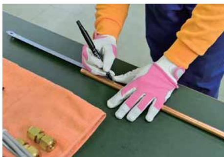
課題図面から銅管の切断長さを読み取って切断箇所をマーキングする。
