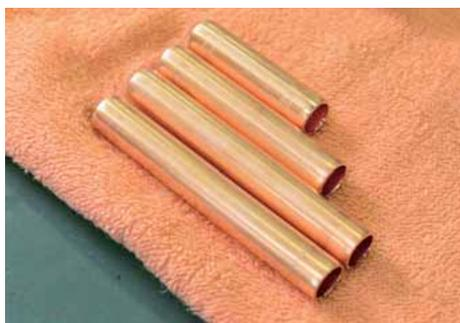
管端が真円であること、バリ取りが完了していること、管内面が清浄であることを確認する。
