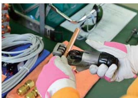
銅管の外径に合ったサイズのパイプカッタを使用する。パイプカッタにより銅管を正しく直角に切断する。パイプカッタをゆっくり締め込み銅管の変形がないように切断する。
