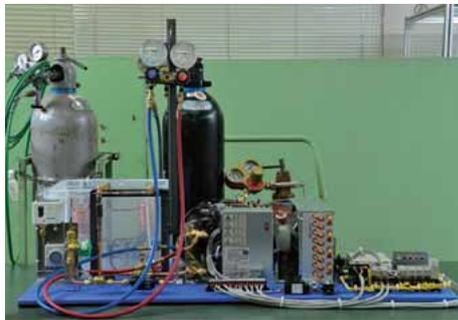
装置の運転を行い、高圧・低圧、圧縮器出入口温度、膨張弁（キャピラリチューブ）前後の温度などを確認し、冷却運転ができているかを確認して完了。
