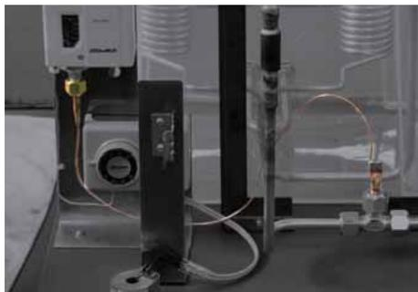
組み立てた連絡配管部分のキャピラリチューブ（左写真カラー部分）をりん銅ロウを使用してロウ付けする。
