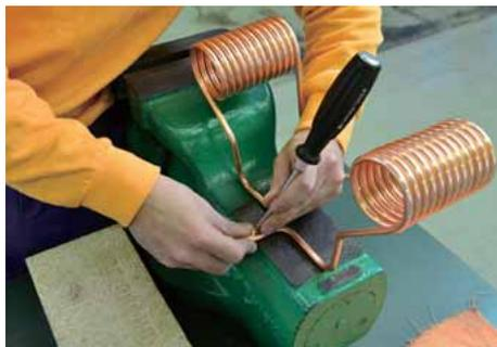
挿入した2本の銅管が動かないように貫通ドライバを使用して銅管を潰し、仮止めを行う。
