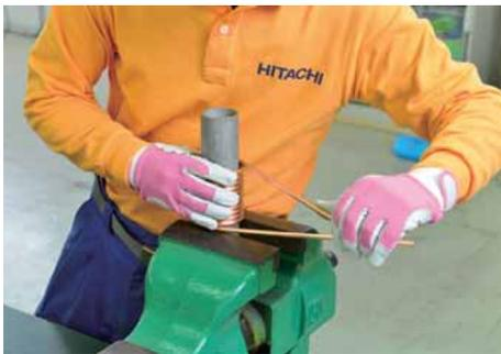
銅管の曲がり角度を課題図面に合わせるため、バイスを利用して微調整する。
