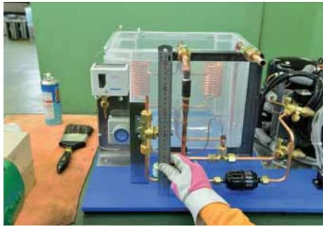
支持金物Bの垂直度を確認し、位置の微調整をする。
