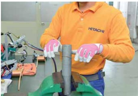
配管用炭素鋼鋼管ジグをバイスに固定し、キャピラリチューブを巻き付ける。
