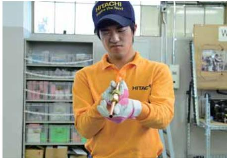
銅管、フレア継手の直線性を確認する。
