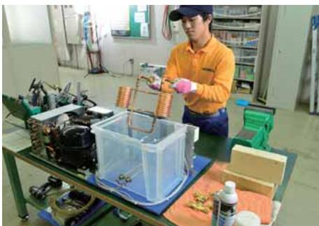
水槽に製作した蒸発器を置く。
