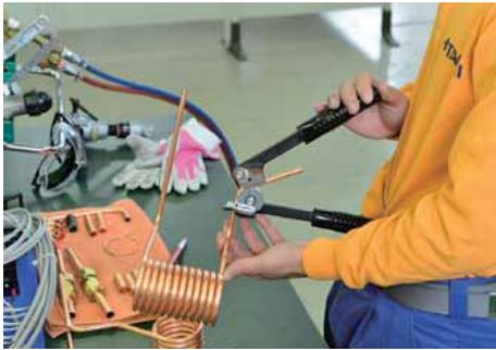
パイプベンダを使用して丁寧に曲げ、曲げ方向を確認する。
