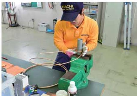
配管用炭素鋼鋼管ジグを利用し、銅管を曲げる。
