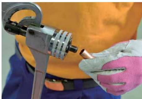
切断した銅管の拡管を行う。
