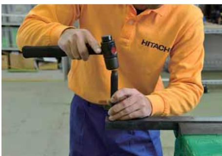
ドリルの先端が逃げないようにセンターポンチでポンチ打ちする。
