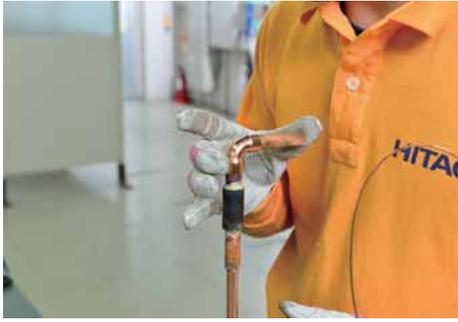
窒素ブロー用キャップと窒素ブロー用細管を取り付ける。
