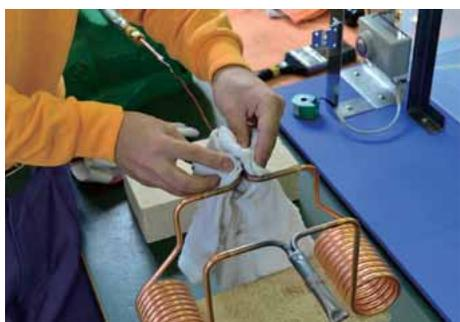
濡れたウエスを使用して加熱部を冷却する。
