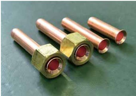
フレアナットを正しい方向で、銅管にはめ込む。
