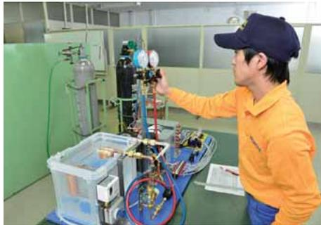
ゲージマニホールドの圧縮機高圧側及び低圧側のゲージ圧を読み取る。
