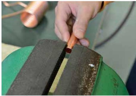
バイスを利用して、2本のパイプを挿入できるように変形させる。
