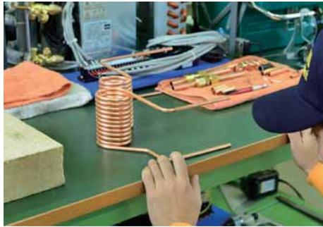
作業台に載せて平坦さを確認する。
