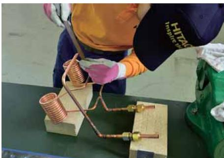
課題寸法に合致していることを確認したのち、取り付け部分が動かないようにプライヤで銅管を軽く潰して固定する。
