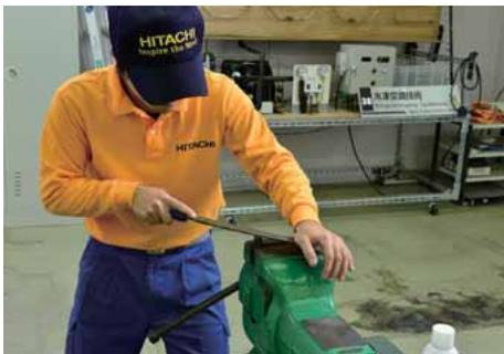
ヤスリを使用して、切断面を仕上げる。
