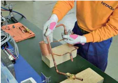
別々に製作したパーツを課題図面のとおりに取り付け、安定した状態でロウ付け接続ができるように耐火レンガを使用して固定する。
