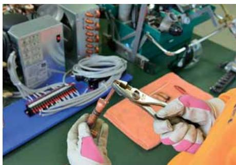
キャピラリチューブを挿入する管端を、挿入できるくらいまでプライヤで加工する。
