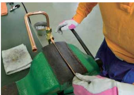
バイスを利用して銅管をかしめる。キャピラリチューブの両端とも同様に加工する。
