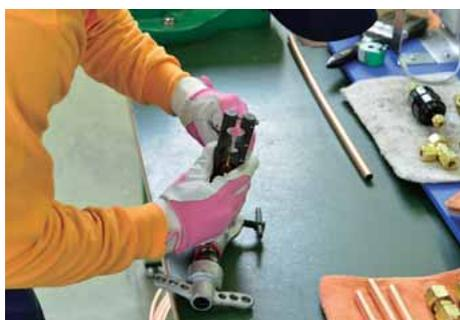
フレアダイスにフレアポンチをかませ、フレアポンチのセンタを銅管の中心にくるようにセットする。
