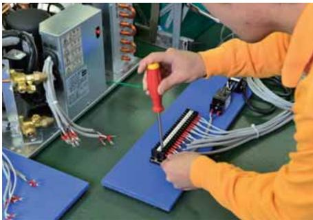
制御箱の電線を電源端子台の各端子に結線する。
