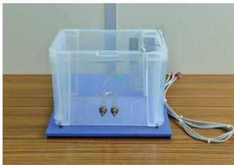
水槽に課題寸法の穴をあけ、電気ヒータを固定する。スペーサを使用して、ベース板に取り付ける。穴あけ作業は、ステップドリルを使用してもよい。
