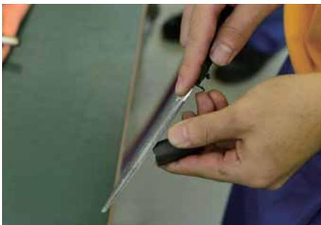
ヤスリを使用して、鋼管の外面のバリ取りを行う。
