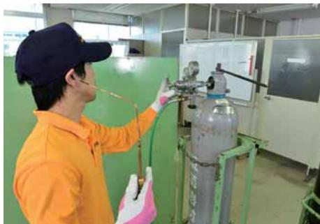
窒素ブローに適切な流量となるように供給圧力を調整する。
