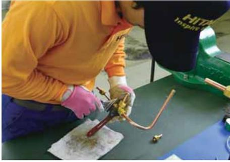
直線方向のフレアナット（赤丸）を確実に締めつける。
