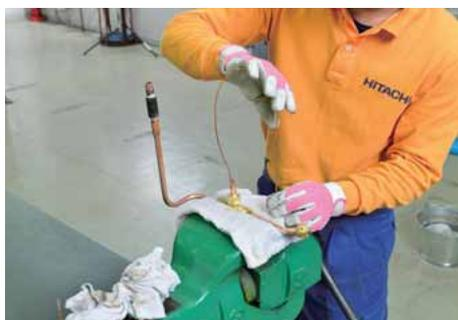
継手部分を利用してパーツをバイスに固定し、組み立てる。
