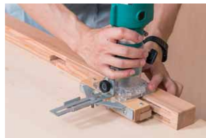
【平几帳面の加工】 R棧～下棧のホゾ穴間の平几帳面をトリマーで加工する。
