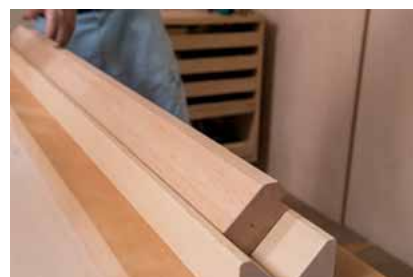
【面取り】 面取り台に框を載せ、カンナで墨付け線近くまで加工する。
