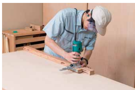
【平几帳面の加工】 R棧～下棧のホゾ穴間の平几帳面をトリマーで加工する。
