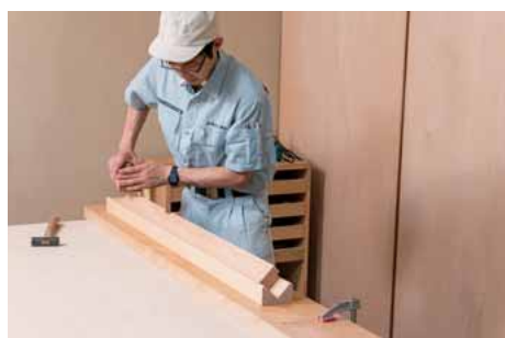
【面取り】 面取り台に框を載せ、カンナで墨付け線近くまで加工する。
