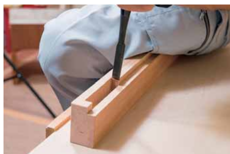
【上棧接合部のカタ加工】 カタの段差部をノミで加工する。
