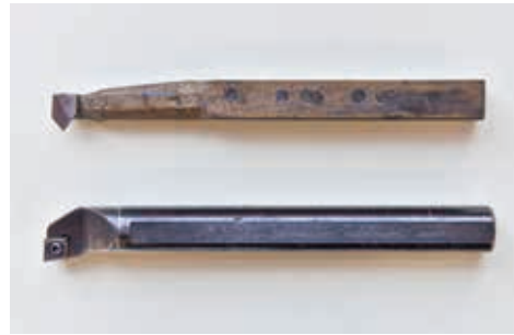
写真上から、中ぐり面取りバイト、超硬チップ付中ぐりバイト（ボーリングバーの径はφ20以下を使用する。）
