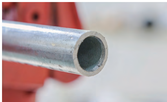
バリ取り完了後の端部の例
