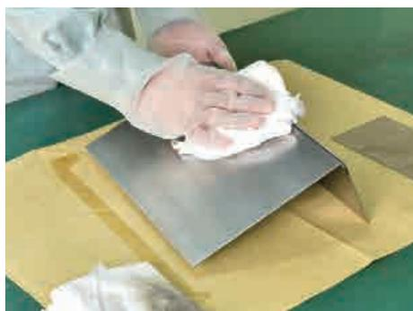
③ 油脂汚れをラッカーシンナーを染み込ませたウエスを使って拭き残しがないように被塗装物を拭き上げ、その後、乾いた清浄なウエスで拭き取る。
