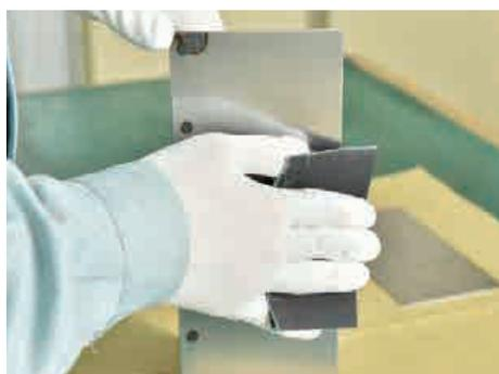
④ 研磨布P100を手につか、または、あてゴムを使用して被塗装物の表面のさび落とし及び溶接部と周辺バリ取りをする。
