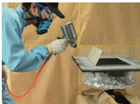
① 調色が完了した塗料の入ったスプレーガンを準備し、スプレーガンの吐出量調整つまみで塗料の量を調整するとともに、パターン調整つまみも適正に調整する。
