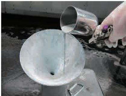
(2) 洗浄液（シンナー）をカップに入れ、カップ内部の塗料をブラシを使って丁寧に洗い落とす。
