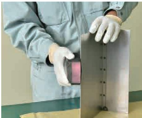
素地調整完了後の被塗装物
