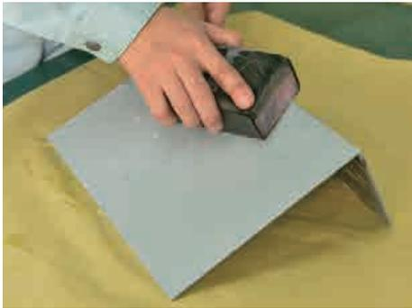
② 耐水研磨紙P400を水に浸けて研磨面を濡らす。
