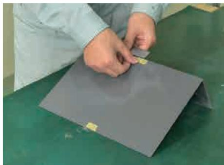
② 養生しようとする箇所の概ねの位置をものさし等で測り、小さく切った養生テープを貼る。
