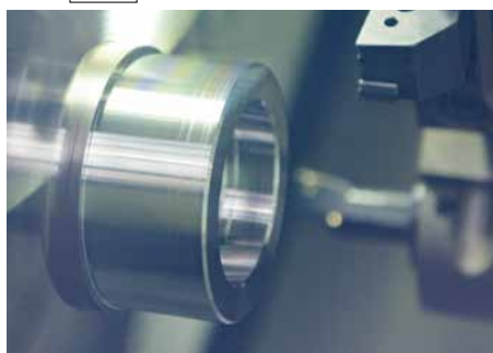
内径仕上げ加工の様子
