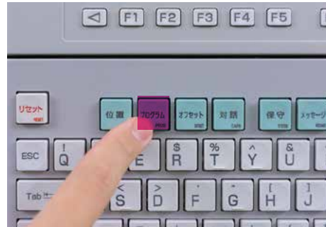
NC操作パネルの「プログラム」を押す。
