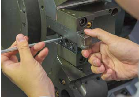
外径・端面荒加工用バイト
