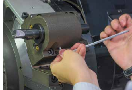
内径荒加工用バイト取付け
