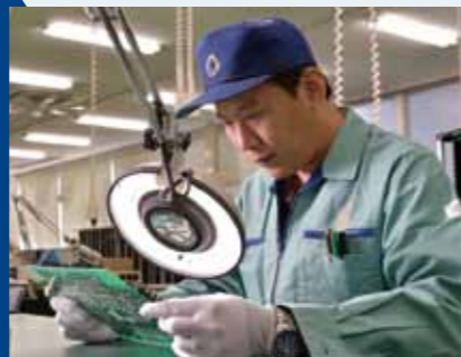
目視による基板検査
