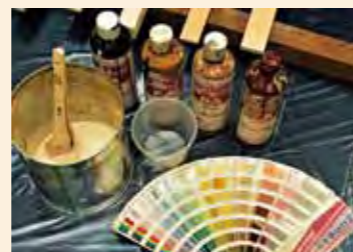
▲日土工が定めた色見本をもとに調色する。赤、黄、黒、紺、白の5色の塗料を、経験に基づいた感覚で混ぜあわせて指定された色を作っていく。
