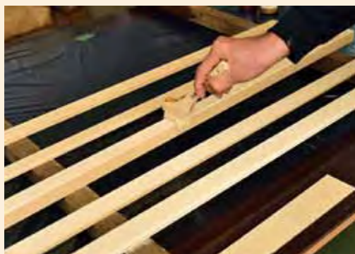
▲「木工塗装作業」の検定は1級から取得している。建具等で使われる部材はまず必要な塗装が施され、その後、建具職人によって組み立てられる。
