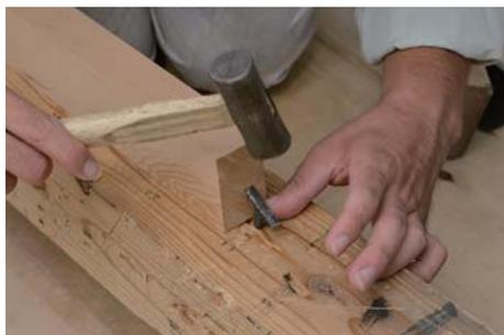
下に置く台は中凹の部材を使用する（太鼓になっていると被加工の部材が安定しない）。
