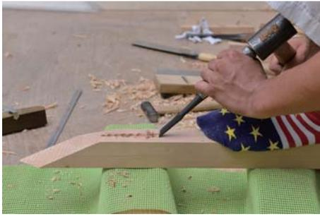
のみでほぞ穴を掘る。のみは溝の幅より一回り小さい幅の
