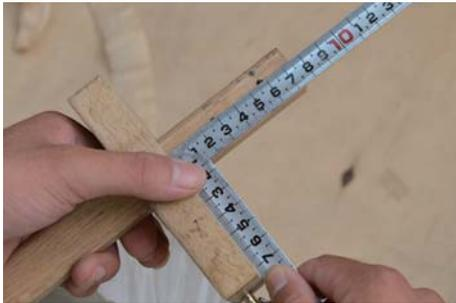
けびきの棹を調節し、部材の規定の幅に刃を合わせる。
