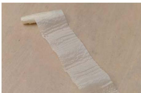
切りくずはかんなの幅で連続して出てくるように、突出し量の調整をする。
