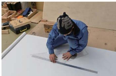
現寸図の作成には主に三角定規と直定規を、線を引くには鉛筆またはシャープペンシルを使用する。
