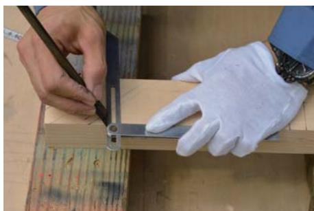
同じ勾配の墨線は、自在定規を用いる。自在定規の角度がずれないようにしっかりとねじを締める。
