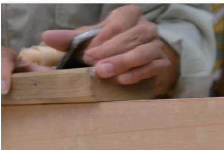
罫引いた所まで削り、材料の厚みを調整する。
