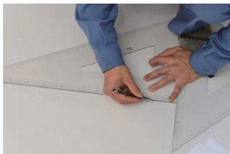
現寸図を早く正確に描くためには、三角定規と直定規を組み合わせ、上に乗って押さえ、線を引く。定規は動かさずに、自分が中腰で身体を動かす。
