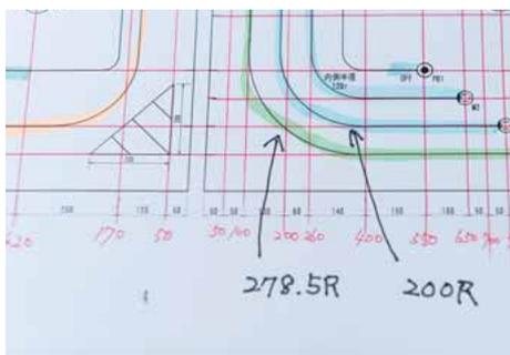
1箇所だけ半径が指示されるので、等間隔な他の配管の
