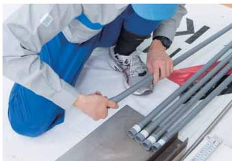
テープがついた凹型治具を樹脂管の先端に差し込み、テープをつける。
