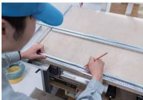
パイプの先端から曲げる位置に印を付ける。
