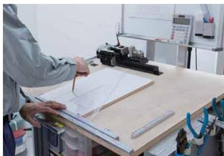
部材の取付位置を制御機器取付用板の上に罫書く。
