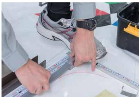
ボックスの接続位置に合わせた治具を差し込み、浮き上がりをつける。
