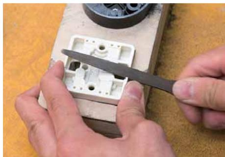
鋸刃でランプレセプタクルA, Dとコンセントに切り欠きをつけた後、
