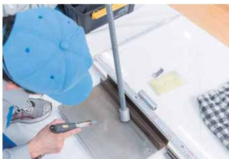
テーパ部分を治具で保護し、浮き上がり部分を加熱する。
