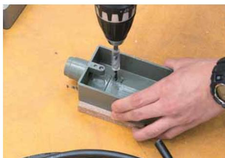
パイロットランプ (PL) 用のボックスの裏面にも同様に取付穴をあける。
