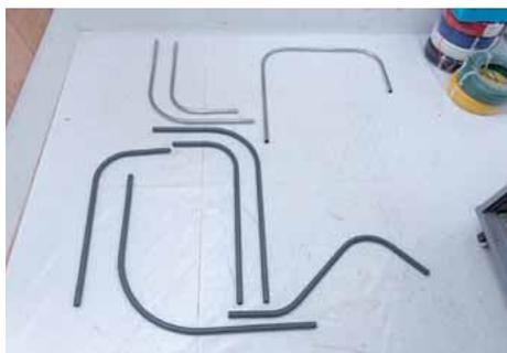
加工した金属管、合成樹脂管。
