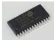
図 2.1 MP3 デコーダ VS1011e (SOP パッケージ)
