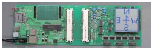
図 2-6 カップリングボードを用いる接続方法
