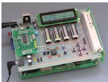
図 2-7 スタックボードを用いる接続方法
