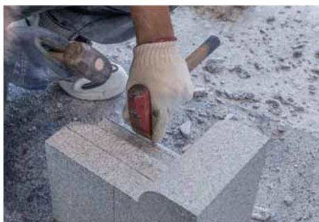
身体の向きを変えて、こやすけとせつとう、エアーのみを使用して、正面の凹R部分を切削を続ける。
