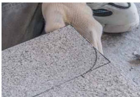
天端面の作品に残る部分（正面右側部分）を正確に切削する作業を終えたところ。
