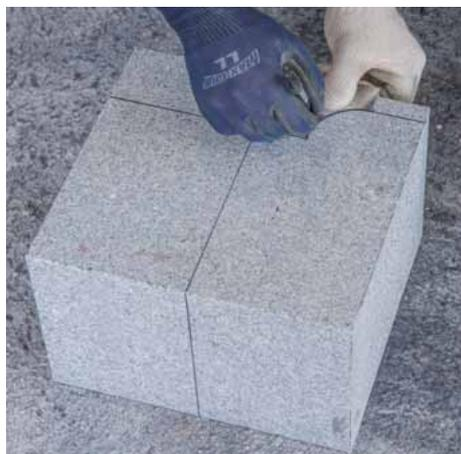
テンプレートを使用してR部分を下端面に墨付けする。
