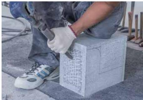
右側面のふち取りより内側部分をエアーのみを使用して切削する。
