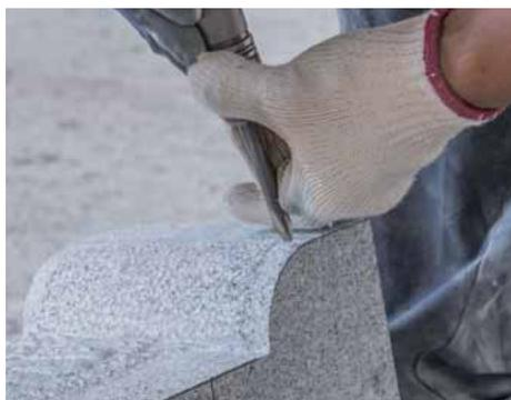
正面右側下部の凸R部のふち取り部分の平滑さを、エアーのみで微調整する。
