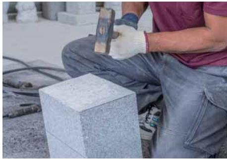
8枚びしゃんを使用して、左側面の作品に残る部分のびしゃん仕上げを行う。
