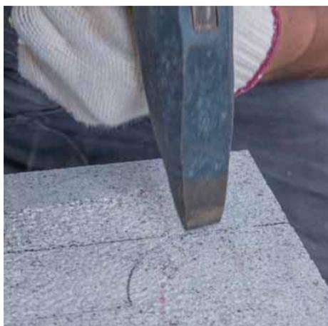
R部分は、刃の幅が短い両刃（たたき）を使用して仕上げる。
