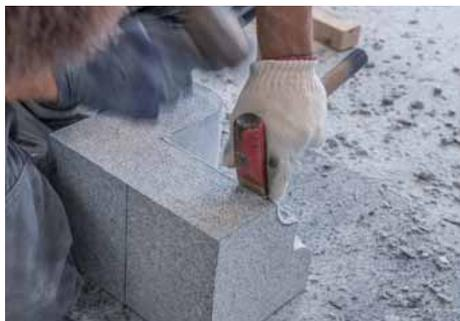
石の向きを変えて、正面の凹R部分を、こやすけとせつとうを使用して、天端面方向から切削する。
