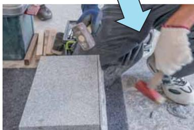
刃先の石に対する角度(手元の上げ下げにより行う)で石の落ち方が変わる。
