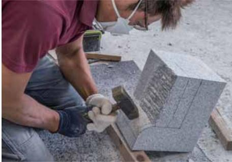
8枚びしゃん、エアーのみを使用して、正面右側の凸R部分の平滑さと入隅部分の微調整を行う。
