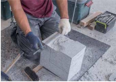
さしがねを利用して加工表面の平坦度を確認する。
