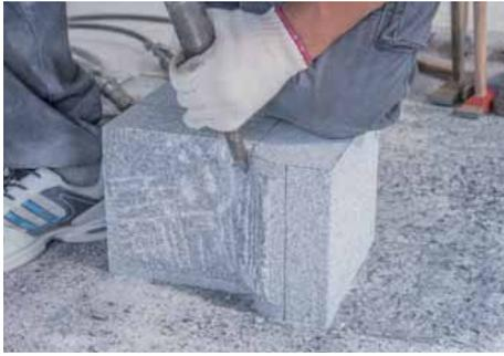
大きな刃のエアのみを使用して、石の配置を変えながら、切削を行う。
