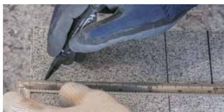
下端面に、正面の切削作業のための墨付けを行う。
