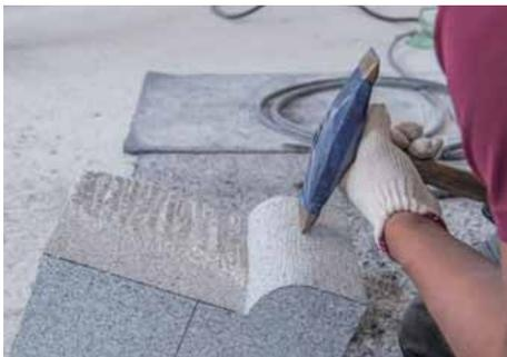
両刃（たたき）を使用して、さしがねで平坦さを確認しながら、小たたき仕上げを行う。
