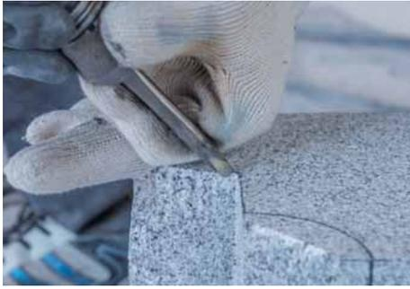
正面の下段凸R部の基準面を、エアーこべらを使用して、左側面からつくる。
