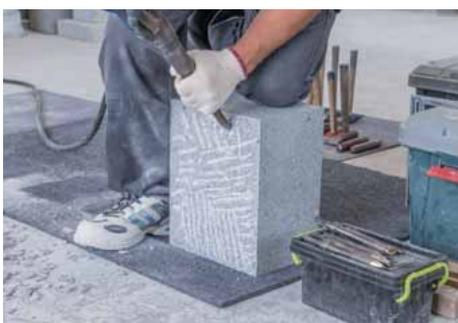
作品の正面左側部分の大きく削り取る部分がマス目状になるように、さらにエアーのみで削る。
