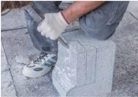
石の向きを変えながら大きな刃のエアのみを使用して、さらに切削する。
