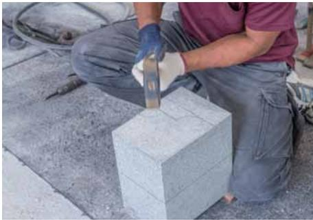
8枚びしゃんを使用して、左側側面の作品に残る部分のびしゃん仕上げをする。
