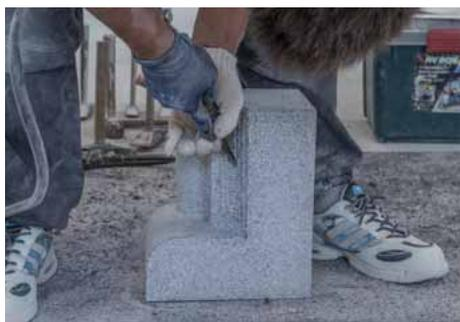
石の向きを変えて、正面上部の凹R面をエアのみを使用して切削する。
