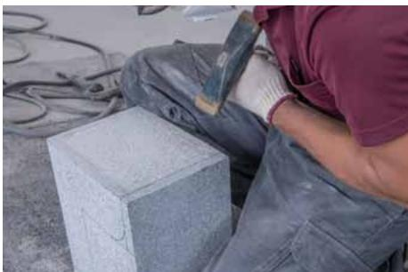
右側面のふち取り部分に、両刃 (たたき) を使用して小たたき仕上げを行う。
