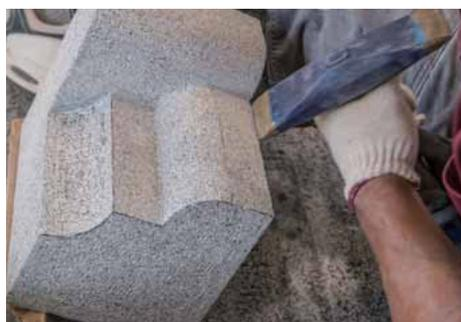
枕木の位置を変えて、両刃（たたき）を使用して小たたき仕上げを続ける。
