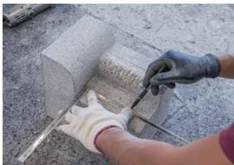
正面の上段凹R面を切削するための墨付けを行う。
