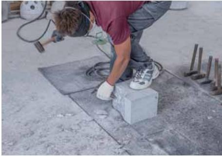
のみを使用して、刃の向きを変えながら、中央部分を削り取る。
