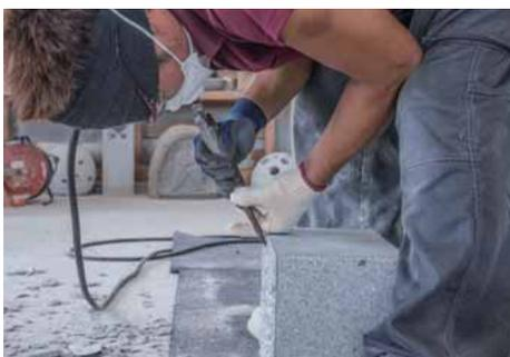
ふち取り作業を行う部分を、エアーのみの刃をのみ（小）に交換して削り取る。
