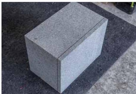
墨付け線を確認し、切削作業を行いやすい方向に石を設置する。
