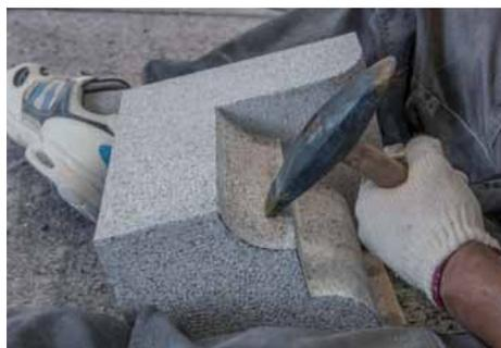
仕上げ用の両刃（たたき）を使用して正面の凹Rのと凸R面の小たたき仕上げを行う。
