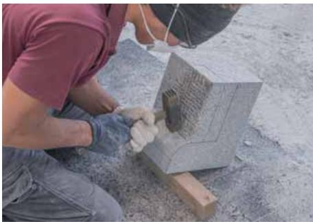
荒（鬼）びしゃん、8枚びしゃんを使用して、正面右側部分のR部分下部と正面下部の平坦部を、石の配置を換えて、びしゃん仕上げを行う。
