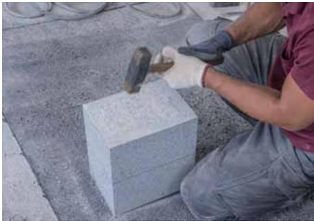
左側面のふち取りより中央部を、荒（鬼）びしゃんを使用して大まかに削る。
