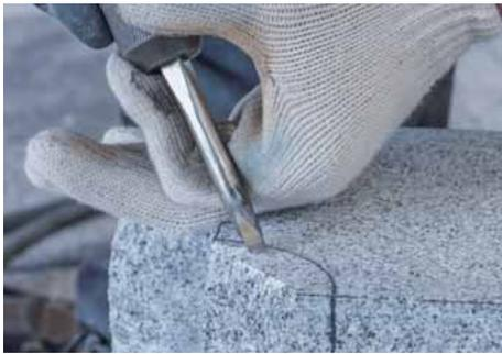
正面の上段凹R部分を切削する際に石を欠くことを防ぐため、エアーこべらを使用して、左側面に溝掘りを行う。
