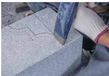
両刃（たたき）を使用して、ふち取り部分の小たたき仕上げをする。
