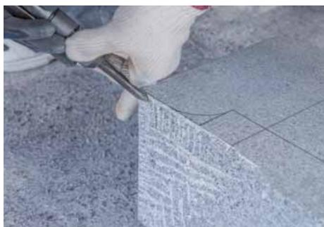
小さな刃のエアーのみを使用して、ふち取り部分より外側の角部分を丁寧に削り取る。
