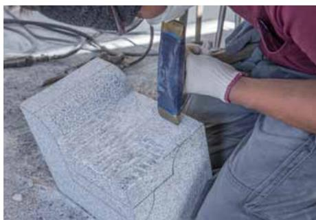
正面下部の大面を、両刃（たたき）を使用して、小たたき仕上げを行う。
