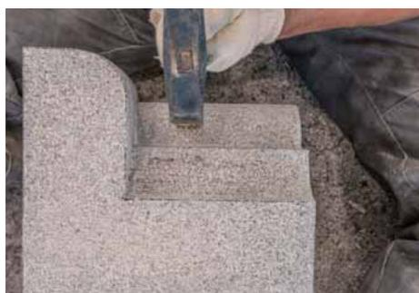
刃びしゃんを使用して、正面上部凹R面の補正を行う。
