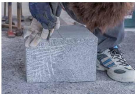
小さな刃のエアークベラを使用して、さらに、正面右側のふち取り部分を平坦に仕上げる。
