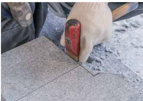
正面の切削を、下端面に墨付けした切削線上にこやすけの刃をあてて丁寧に行う。
