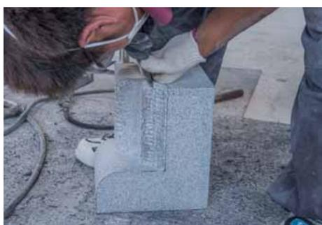
石の配置を変えて、エアーこべらを使用して、正面の凹R面の左側面側の基準面をつくる。
