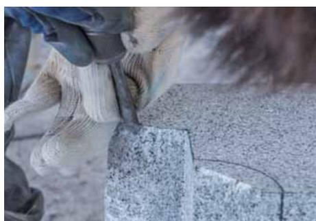
正面の下段凸Rを、エア-のみを使用して、左側面から切削する。
