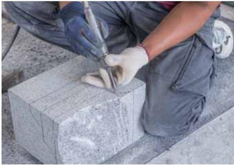
小さな刃のエアこべらを使用して、欠けないように溝を掘る。溝は切削線の1cm程度外側に掘る。
