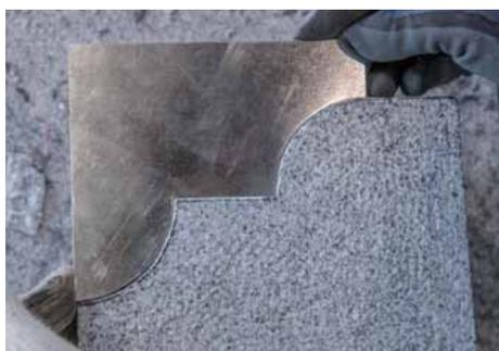
支給のテンプレートを使用して、寸法が合致しているかを確認する。
