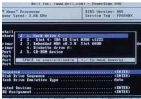
BIOSの最適設定をする。HDDのモード設定、Bootデバイス設定、Core 2 Duo用のCPU設定、ファンの制御、メモリ設定など。
