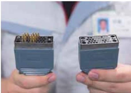
DCEとDTEは接続部を見て判断する。DCEは穴が開いており、DTEは端子が出ている。
