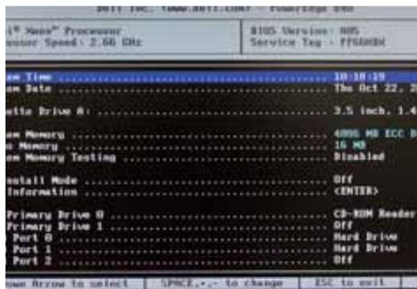
周辺機器が認識しなかったり、不具合が含まれている可能性があるため常に最新の状態を保つようする。まず、PCを再起動し、BIOS設定画面に入る。入り方は、PC起動時の自己診断テスト (POST) の間に<DEL>キーを押すことで入る。
