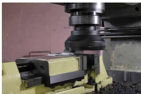
六面体加工は抜き型加工の基準となるため、平行、直角は±0.01mm以内になるよう仕上げる。
