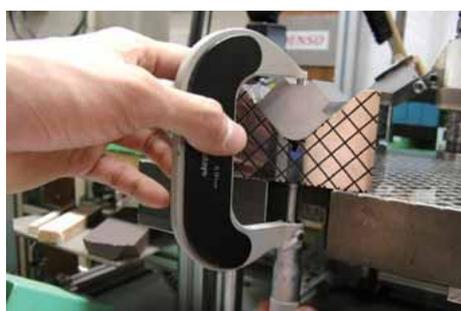
45度面はVブロック、ダイヤルゲージ、マイクロメータを使用する。
