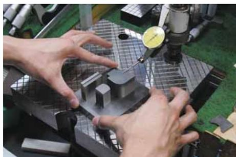
平行度を崩さないようにダイヤルゲージでチェックしながら削る。
