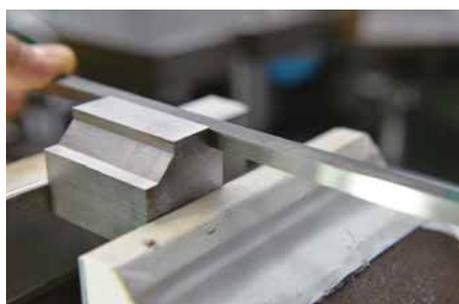
段差部の仕上げには、側面を傷つけないようにコバを加工したヤスリを使う。
