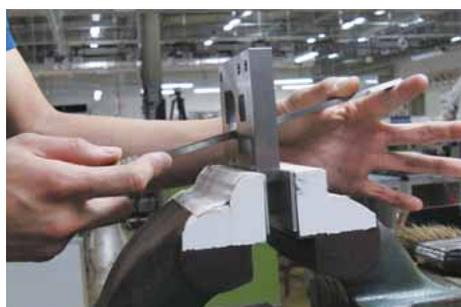
＜ダイプレート抜き勾配加工＞
