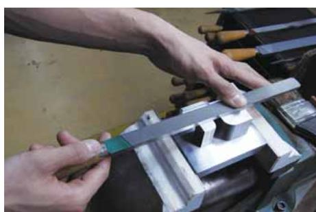
パンチの刃先になる面をヤスリ加工し、機械目を取り、刃先の角部をピン角にする。
