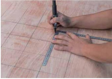
飛行機の胴体及び尾翼部分の製作図を作成する。
