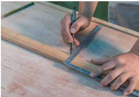
さしがねを利用して、刃定木に直角に目盛り線を付ける。
