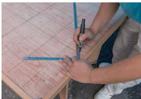
さしがねを使用して、「C」、「H」、「B」、「A」の製作図を作成する。
