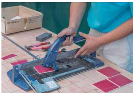
ハンドルのT字部分をタイルに押しあて、センターレール上の切れ筋を中心に左右均等に押し下げ、タイルを切断する。
